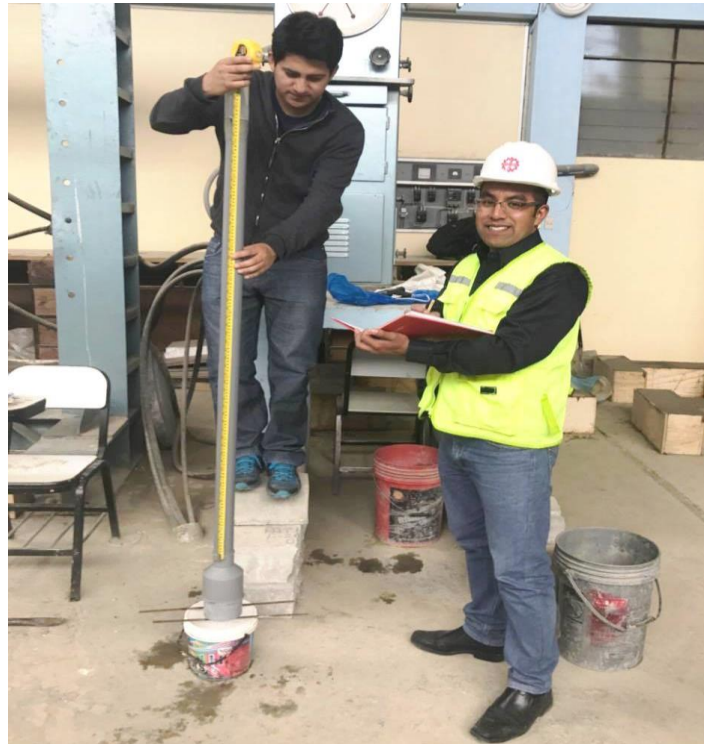
Imagen N° 16: Ensayo de permeabilidad
