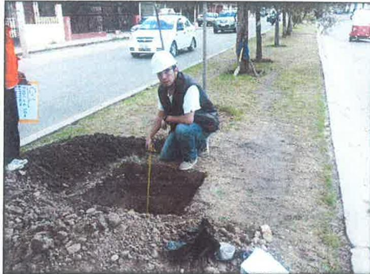
FOTOGRAFIA N° 03: Se muestra la medición de los estratos de la calicata.
