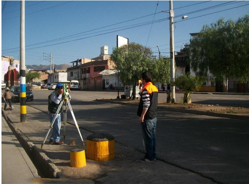
*Img. 3.6.1. El Topógrafo Operador con el Tesista en el levantamiento de la Avenida en Estudio*
