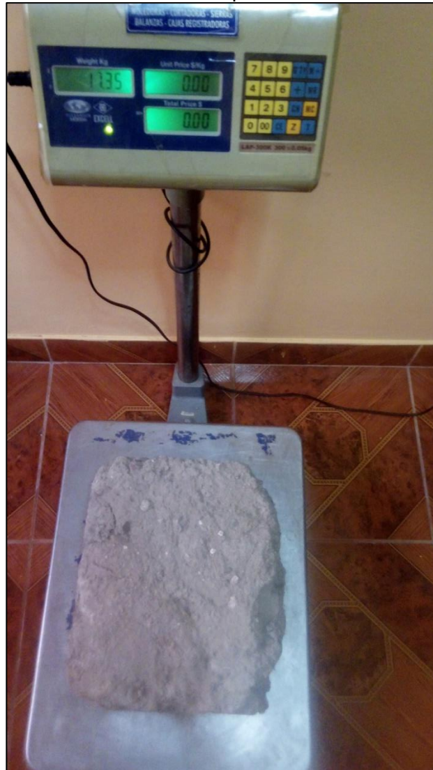
Figura 36: Determinación del peso del adobe de muestra.
