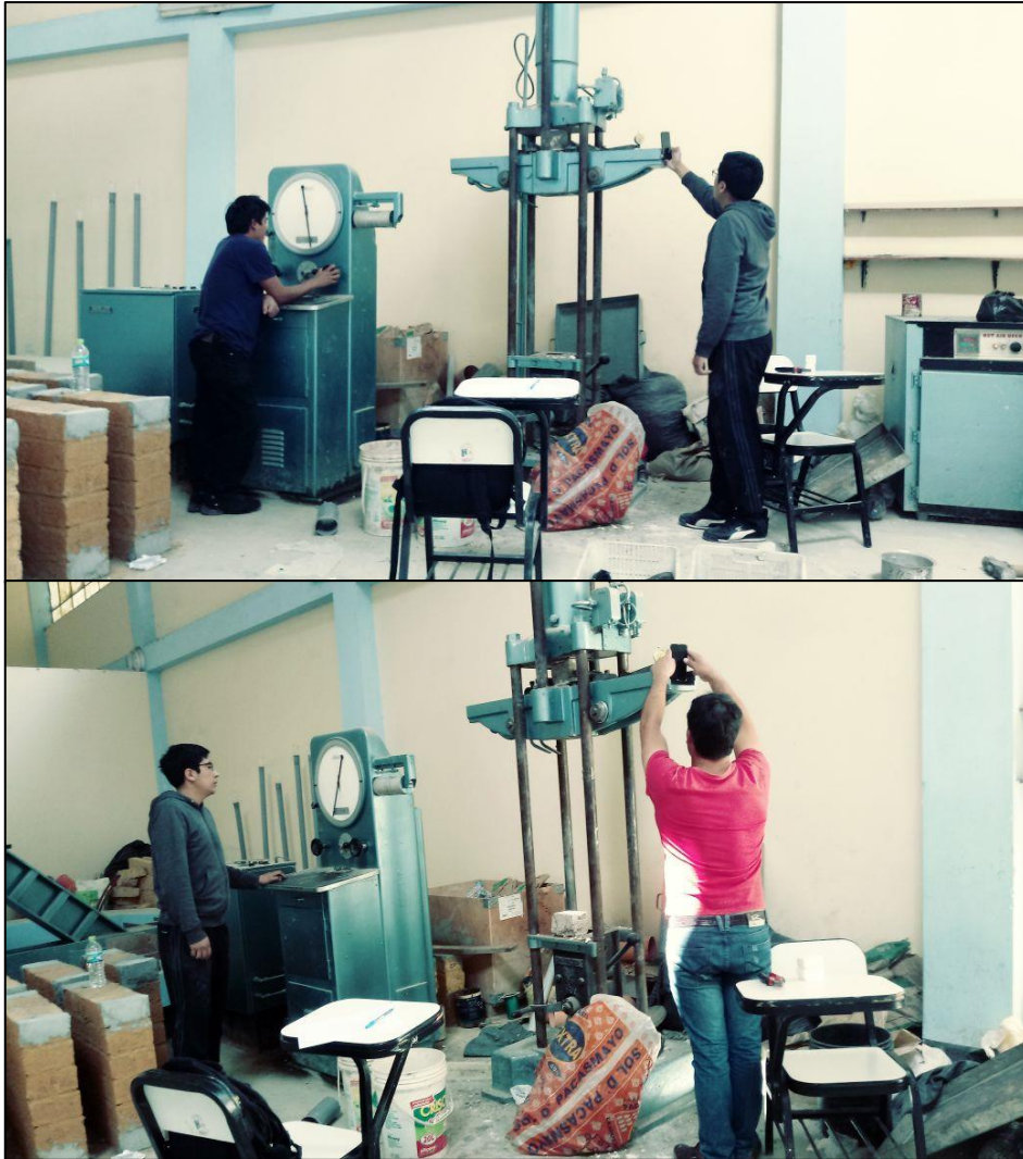
Figura 35: Ensayo a compresión en maquina universal, Laboratorio de Resistencia de Materiales
