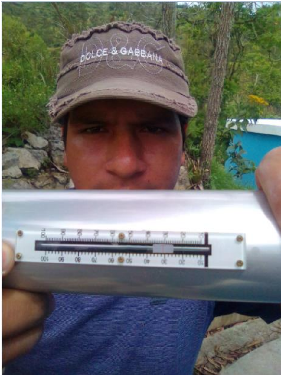
Registro de índice de rebote en el anillo circular.
