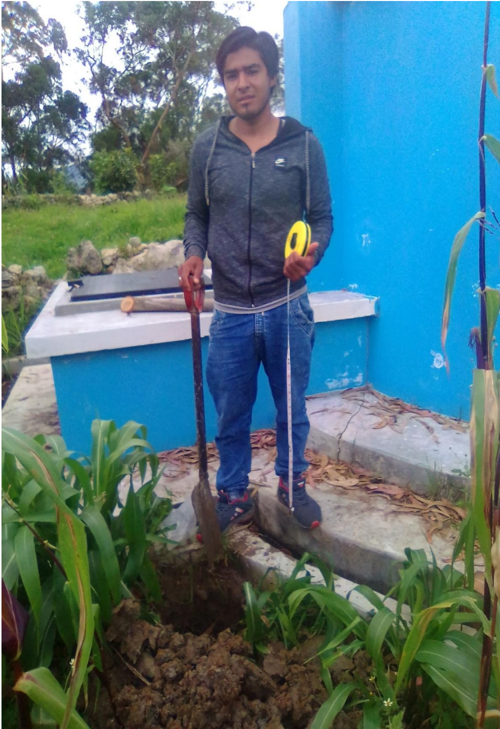
Calicata de 0.90 m de profundidad.
