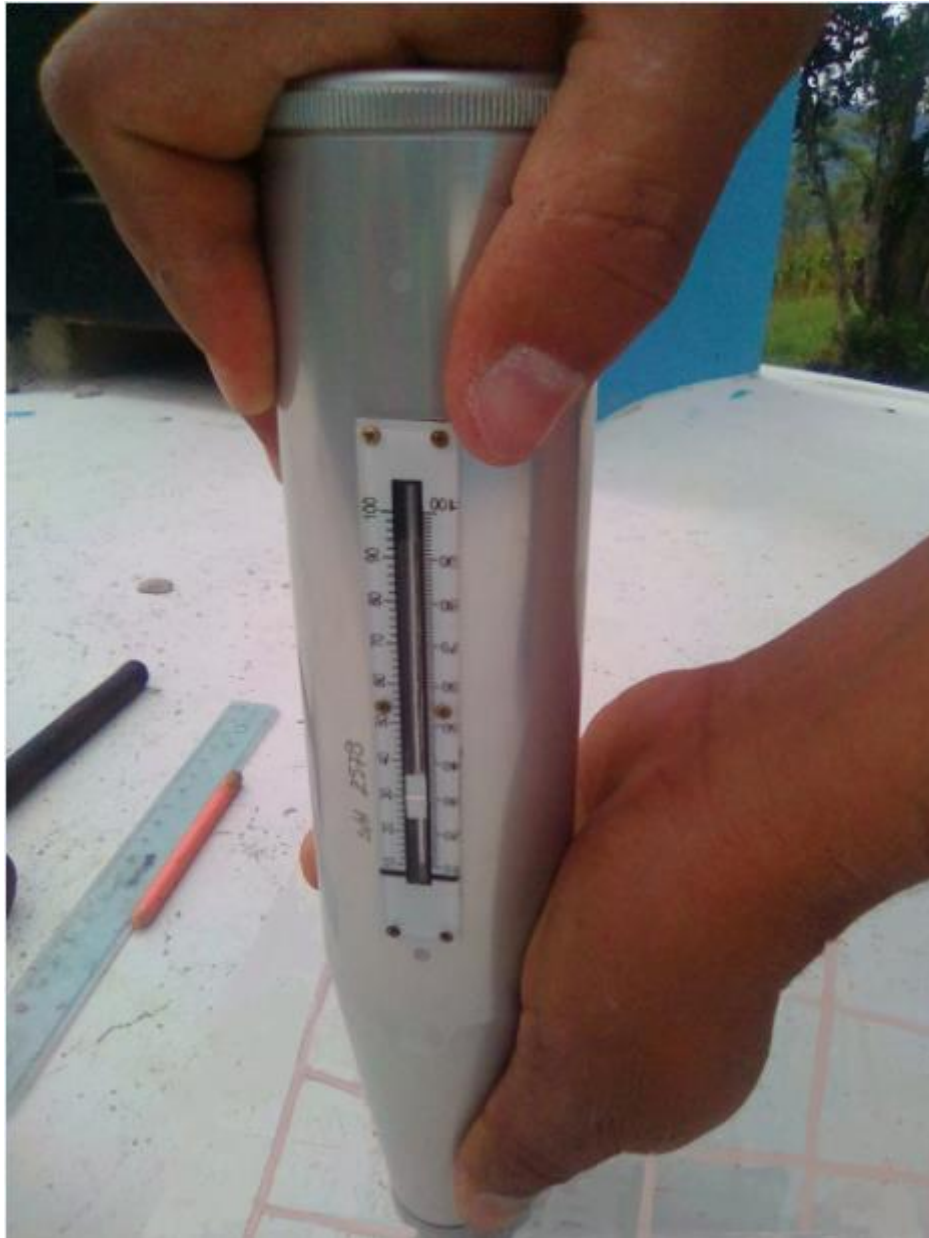
Registro de índice de rebote en la cúpula.
