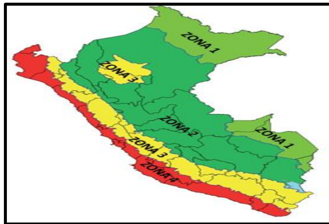
Figura N° 1: Distribución de zonas sísmicas dentro del territorio nacional, Fuente: Norma Sísmica E.030
