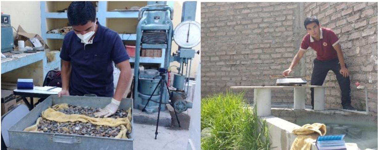
Figura 6.4. Ensayo de peso específico del agregado grueso.
