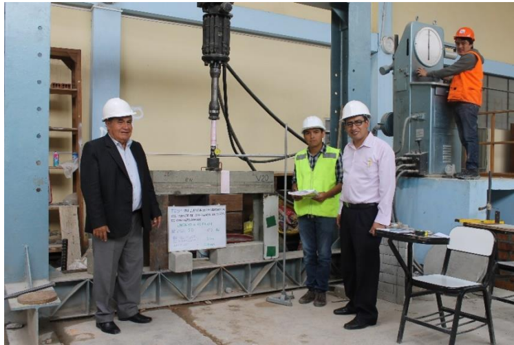
Figura 6.21. Supervisión del Ing. Miguel Mosqueira Moreno e Ing. José Lázaro Lezama Leiva, en el ensayo a flexión de las vigas de concreto armado.
