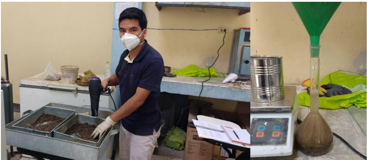
Figura 6.5. Ensayo de peso específico del agregado fino.
