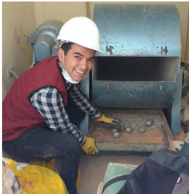
Figura 6.7. Ensayo de abrasión del agregado grueso.
