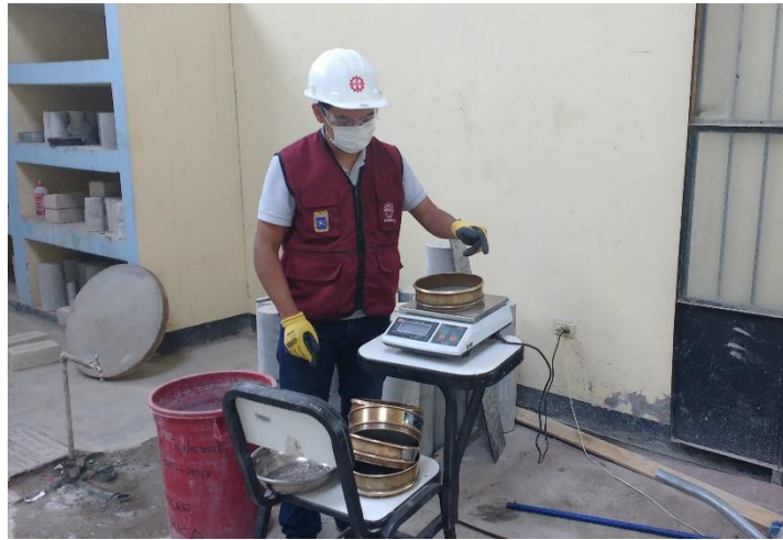
Figura 6.3. Ensayo de análisis granulométrico de los agregados.
