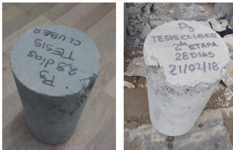
Figura 6.20. Probetas de concreto ensayadas, de la 1° y 2° etapa respectivamente.
