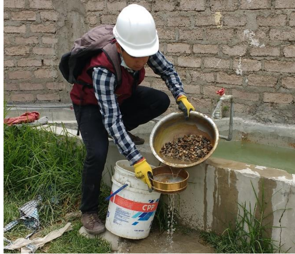
Figura 6.6. Ensayo del porcentaje de finos que pasan el tamiz N° 200.
