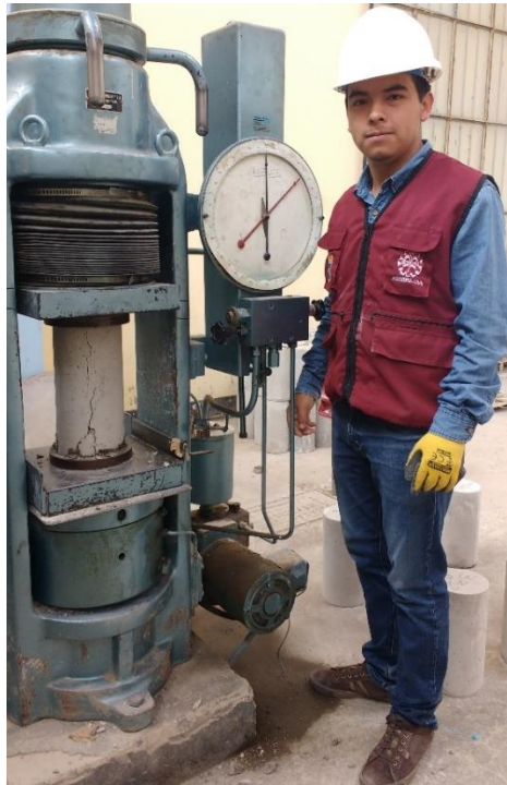
Figura 6.9. Ensayo de compresión de probetas de concreto.
