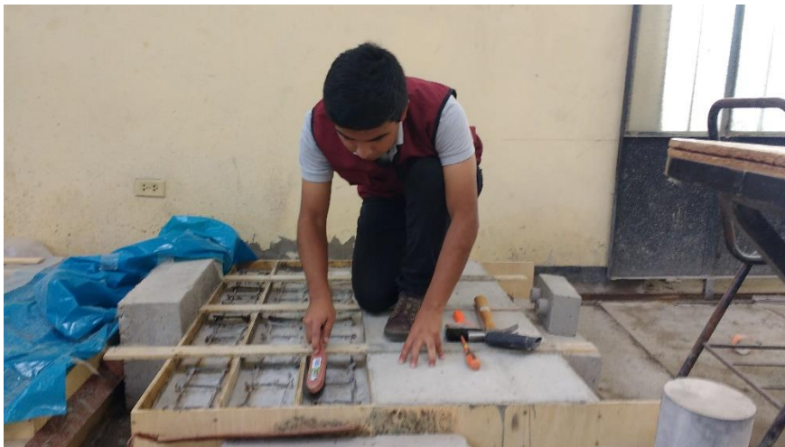
Figura 6.13. Preparación de la superficie de adherencia.
