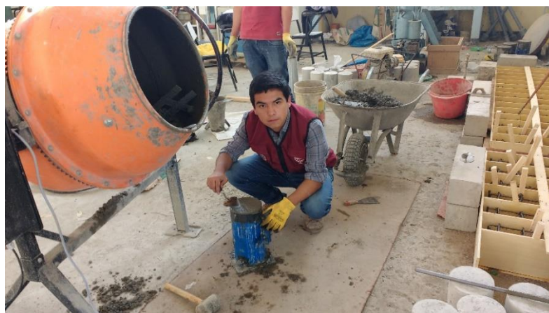
Figura 6.11. Llenado de testigos de concreto-1° etapa.
