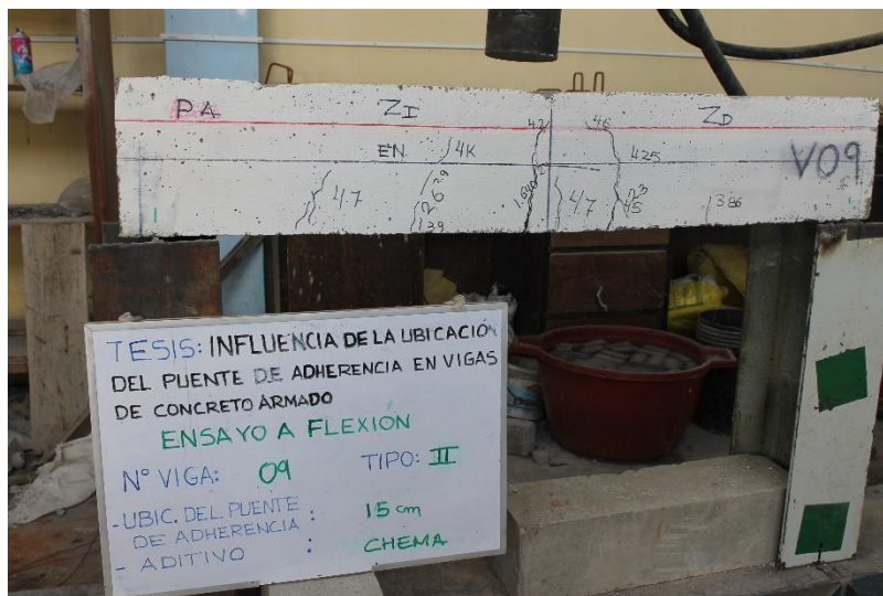
Figura 6.23. Vista frontal de las fisuras generadas de la viga N°9 ensayada a flexión.
