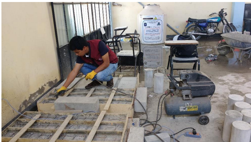
Figura 6.14. Limpieza de la superficie de adherencia.
