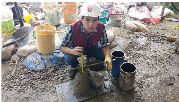
Figura 6.8. Diseño de Mezcla, ensayo de asentamiento del concreto y elaboración de probetas cilíndricas.
