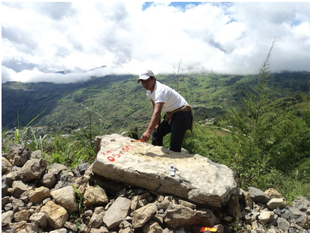
FOTOGRAFIA N° 04. -Colocando las medidas del kilometraje para poder realizar el levantamiento topográfico.
