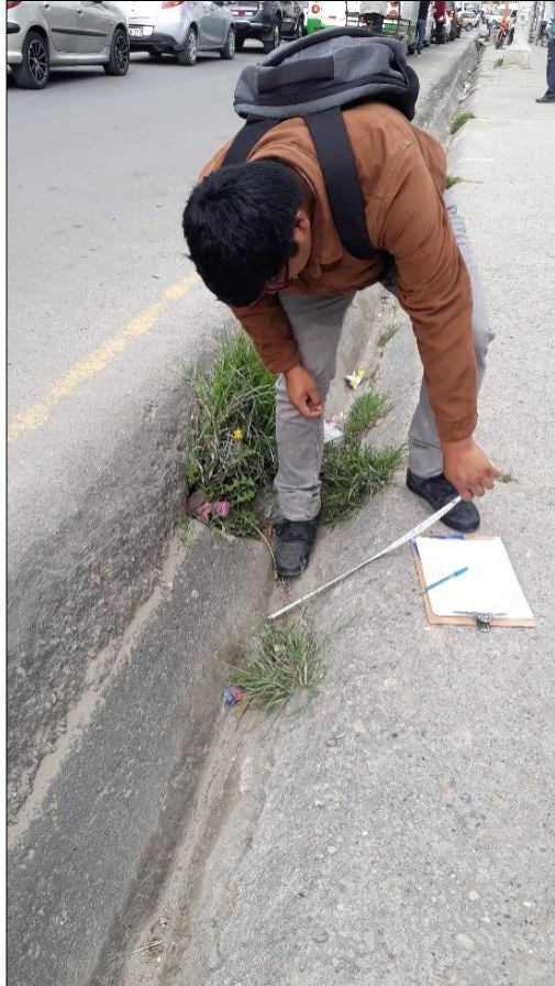
Figura A. 8. Mediciones de las secciones transversales
