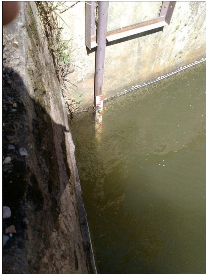
Figura 18. Piezómetro ubicado en estación Ronquillo, el cual registra los niveles de agua cada un periodo de tiempo determinado.
