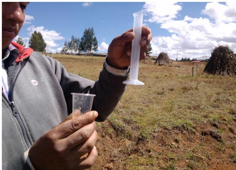
Foto N° 6. Medida de la pluviometria con una probeta
