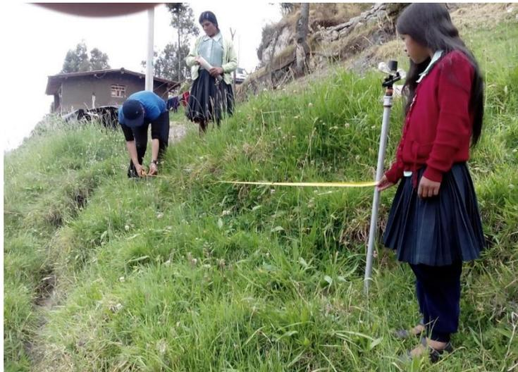
Foto N° 2. Medición para instalar los pluviómetros
