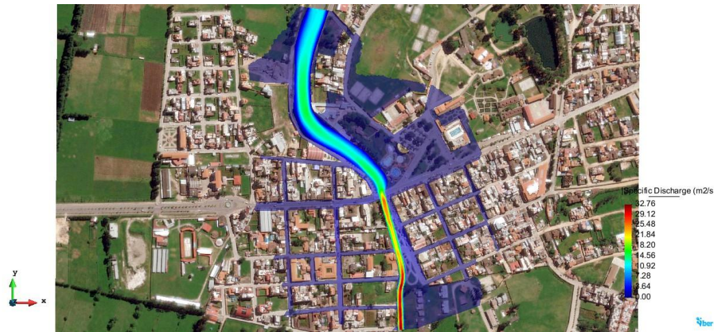
Figura N° 43 Escenario3: Caudal específico m 3 /seg/m
