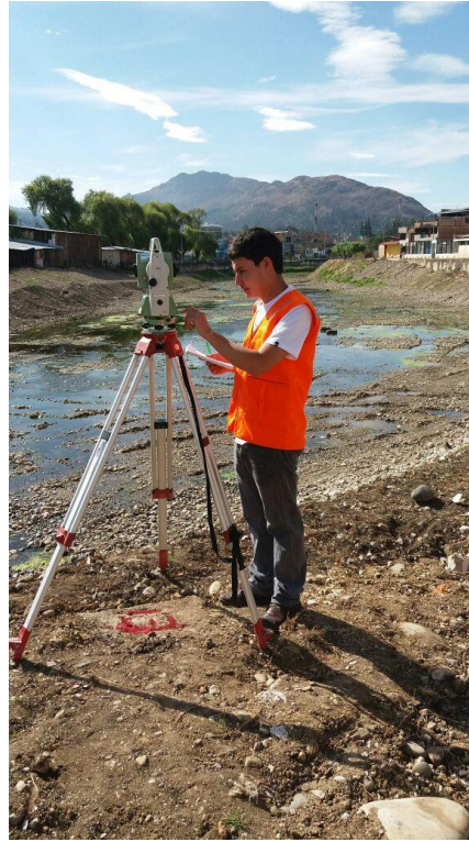
Figura N° 48 BM y estación inicial del levantamiento topográfico
