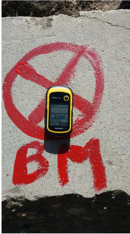
Figura N° 48 BM y estación inicial del levantamiento topográfico
