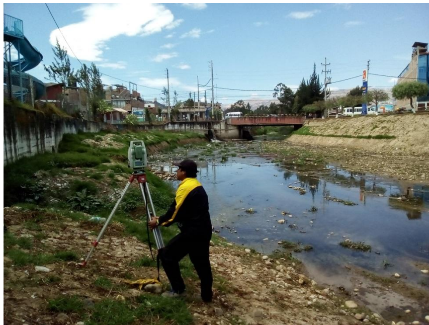
Figura N° 49 Cambio de estación levantamiento topográfico
