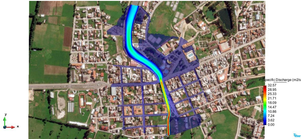
Figura N° 33 Escenario1: Caudal específico m 3 /s/m
