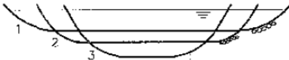
Figura N° 3 Formas de sección transversal con material grueso (1), medio (2) y fino (3) si se conservan iguales las restantes condiciones
