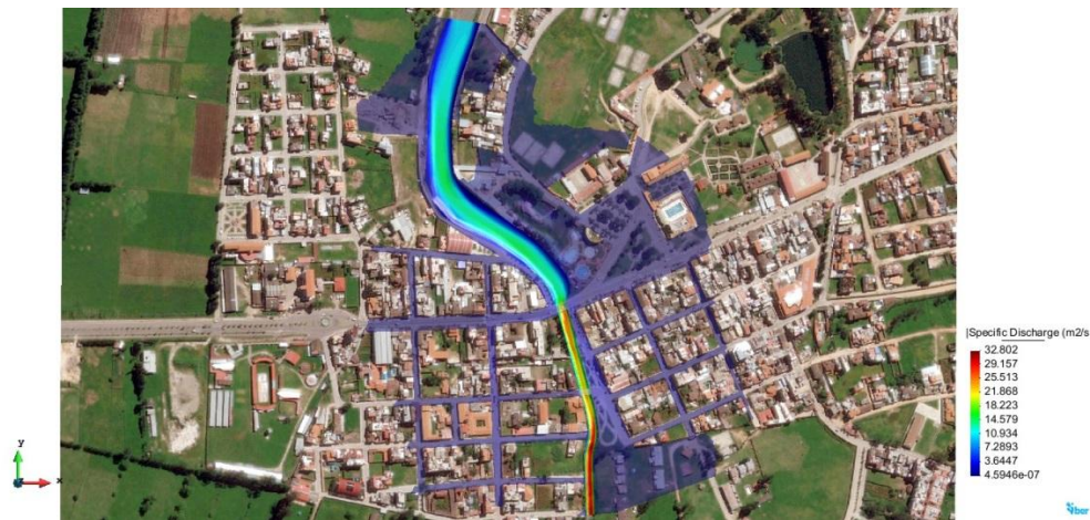
Figura N° 38 Escenario2: Caudal específico m 3 /s/m
