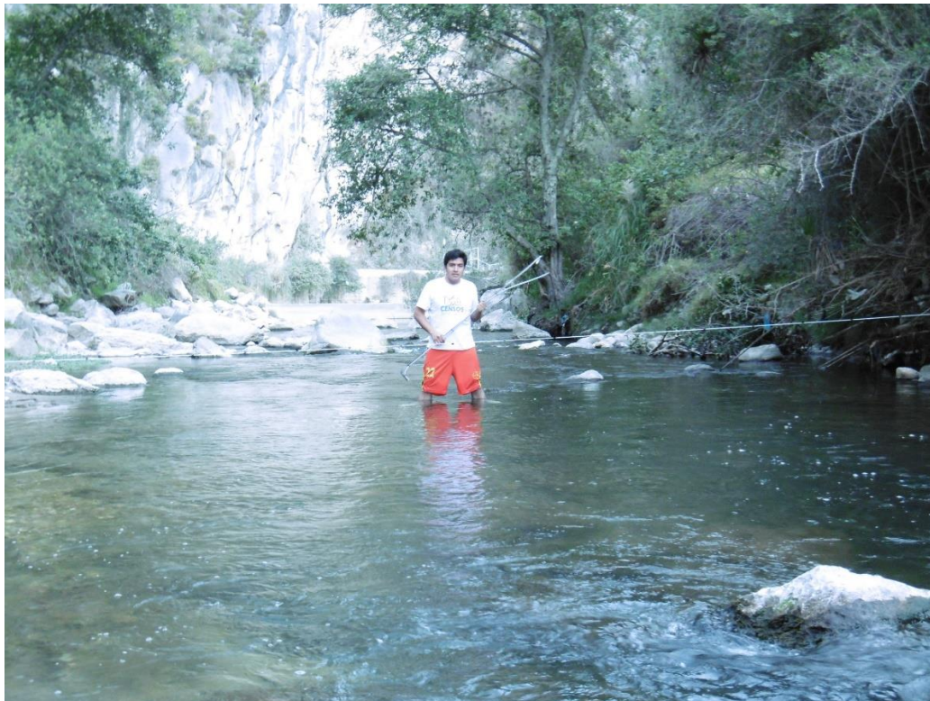
Figura 33. Aforo del río Chonta en una sección ubicada 100 m aguas arriba de la captación el Chicche- tubo de Pitot.
