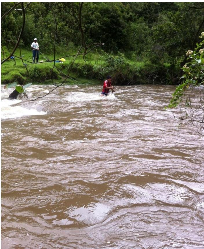
Figura 15. Medición de la velocidad del flujo por el método del flotador.
