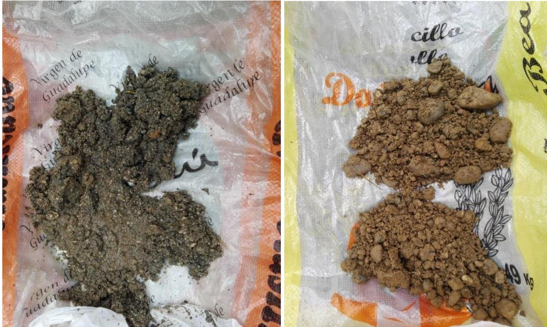
Figura 19. Secado de la muestra extraída del río Chonta, extraídas aguas arriba y aguas abajo de la captación El Chicche.
