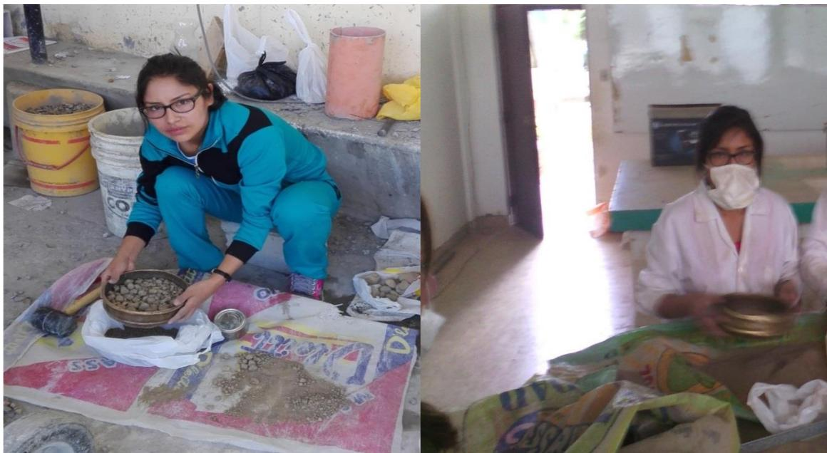
Figura 21. Determinación de los pesos específicos de los sedimentos extraídos aguas arriba y aguas abajo de la captación El Chicche.
