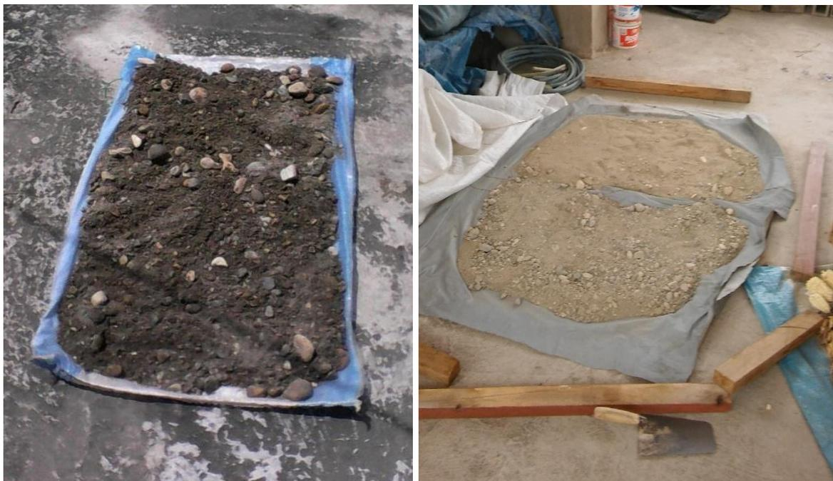
Figura 20. Tamizado de la muestra extraída del río Chonta, aguas arriba y aguas abajo de la captación El Chicche.
