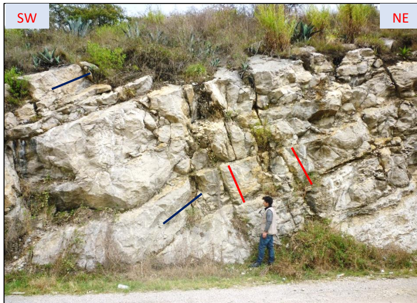
Foto 3.19: Diaclasas con orientación: 01: N114° y Buz 60°, 02: N235° y Buz 88°. Coordenadas: E 744989, N 9274228, Cota 2136 m.s.n.m.
