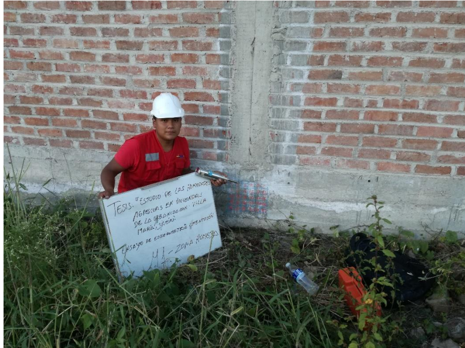
Foto 25: Vista de la muestra 01 en estado húmedo para ensayo de esclerometría.
