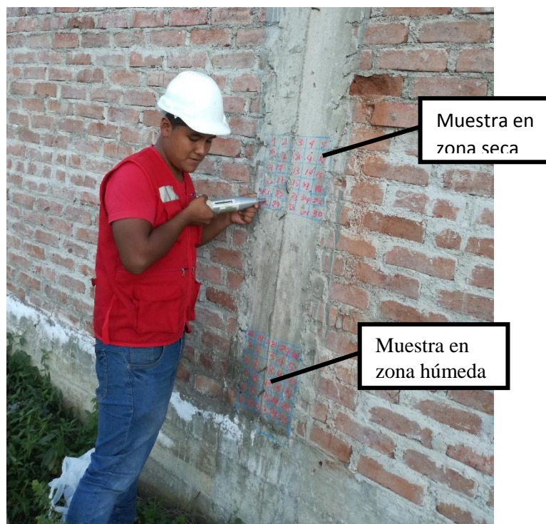
Foto 30: Determinación del Índice del rebote para determinar la resistencia a la compresión del concreto en columna.
