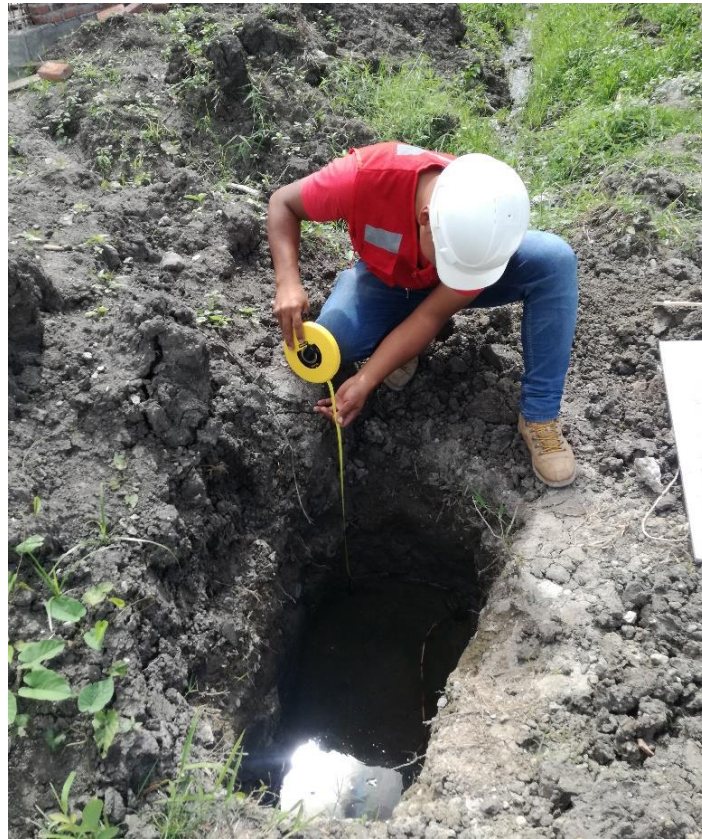
Foto 19: Medición del nivel freático en pozo de exploración.
