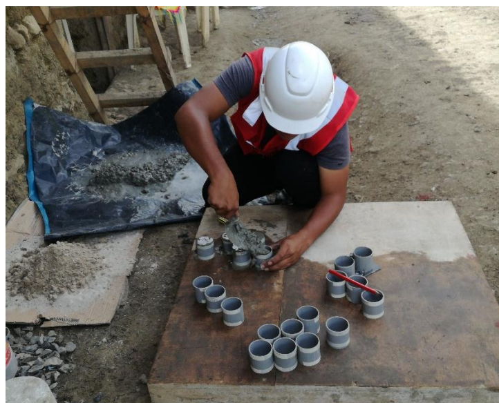
Foto 36: Elaboración de especímenes de concreto.
