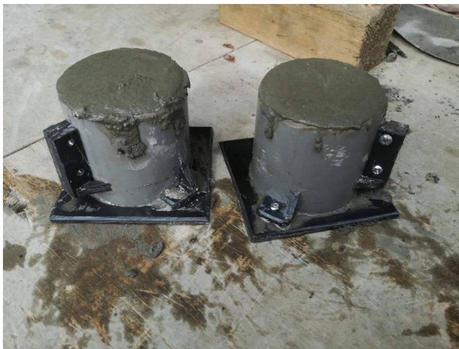
Foto 37: Moldes y concreto para especímenes.
