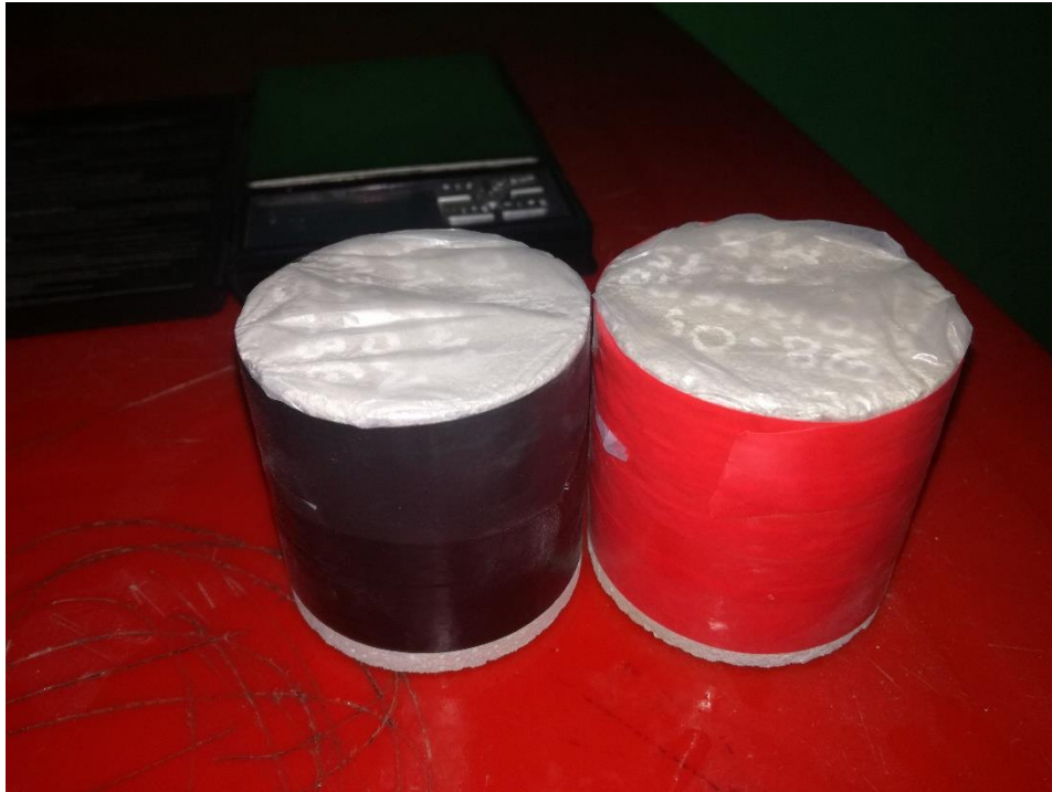
Foto 43: Acondicionamiento de especímenes. Se aprecia la impermeabilización con cinta aislante.
