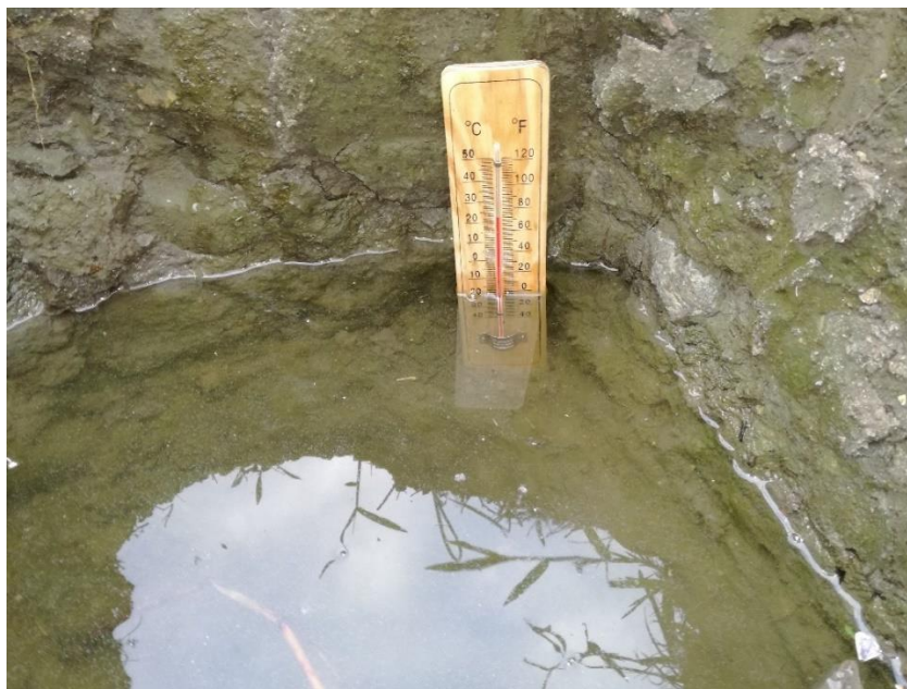
Foto 18: Medición de la temperatura del agua para determinar la temperatura de rocío.
