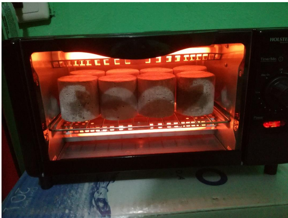
Foto 42: Secado de especímenes de concreto y mortero para eliminar la humedad.
