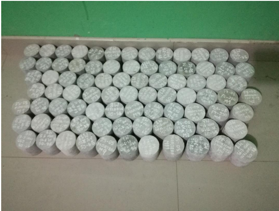
Foto 41: Muestras de especímenes de concreto y mortero.
