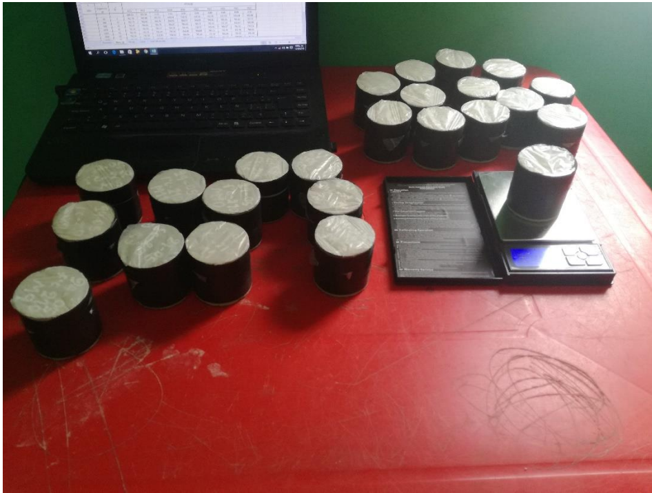
Foto 45: Pesado de especímenes luego de ser sumergidos en agua.
