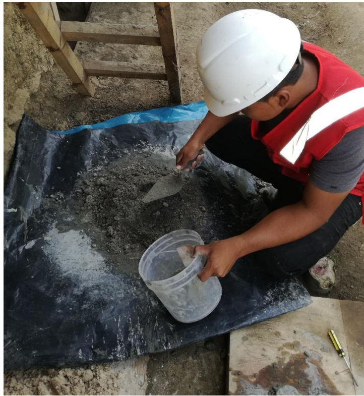
Foto 35: Concreto para la elaboración especímenes.
