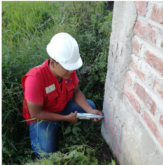
Foto 28: Ensayo de esclerometría para determinar en Índice de Rebote.
