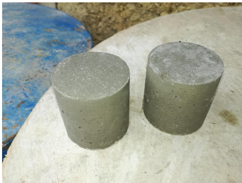
Foto 38: Se puede apreciar los especímenes desencofrados al día siguiente de su vaciado.
