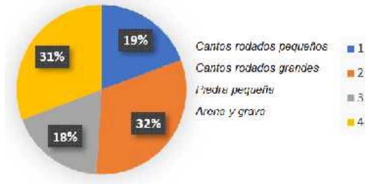
Figura 23. Concentración de sedimentos en muestra N° 1 para prototipo.
