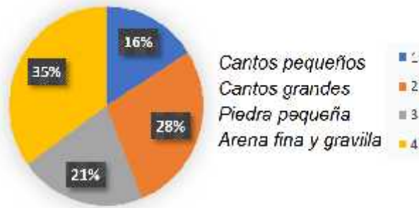
Figura 32. Concentración de sedimentos en muestra N° 4 para prototipo.
