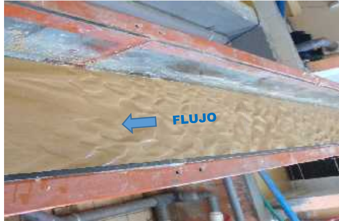
Figura 35. Antidunas generadas en prueba de laboratorio – canal de pendiente variable.
