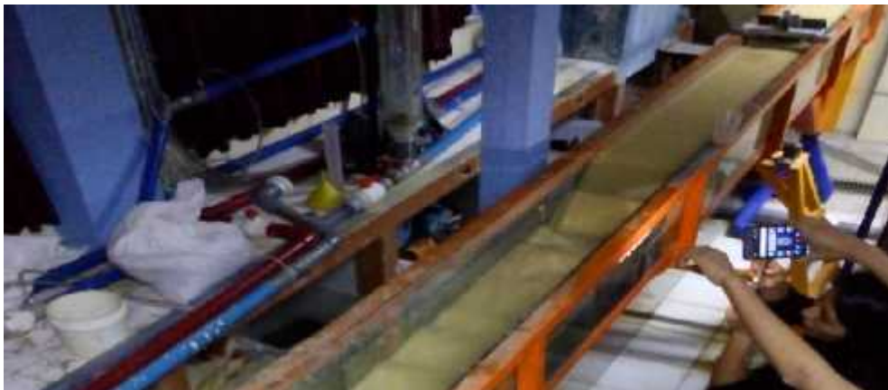
Figura 49. Modelamiento físico en canal de pendiente variable en laboratorio.
