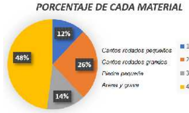
Figura 29. Concentración de sedimentos en muestra N° 3 para prototipo.
