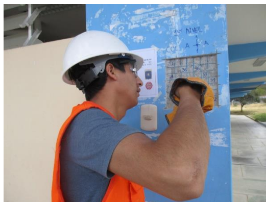
Fotografía 5: Realizando ensayo de esclerometría en Columna A-1 del primer nivel del edificio en estudio.
