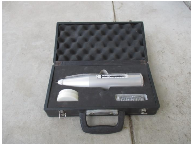
Fotografía 3: Equipo de ensayo: Esclerómetro.
