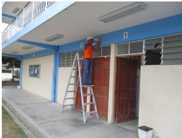
Fotografía 4: Realizando ensayo de esclerometría de Viga A-12 del primer nivel del edificio en estudio.
