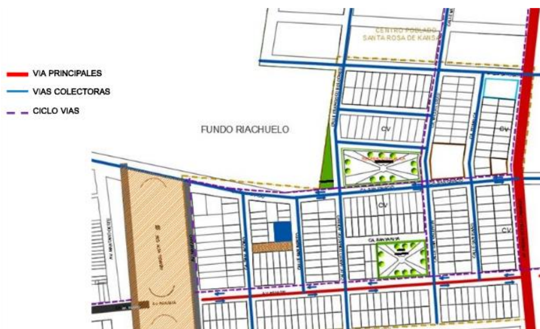
Figura N 2.5: Esquema representativo de vía colectora
