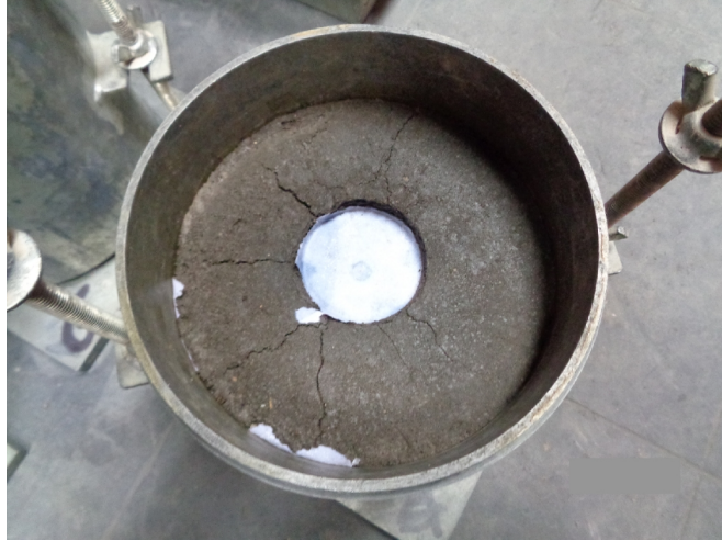
Figura 65. Muestra de suelo después de la prueba de carga – penetración
