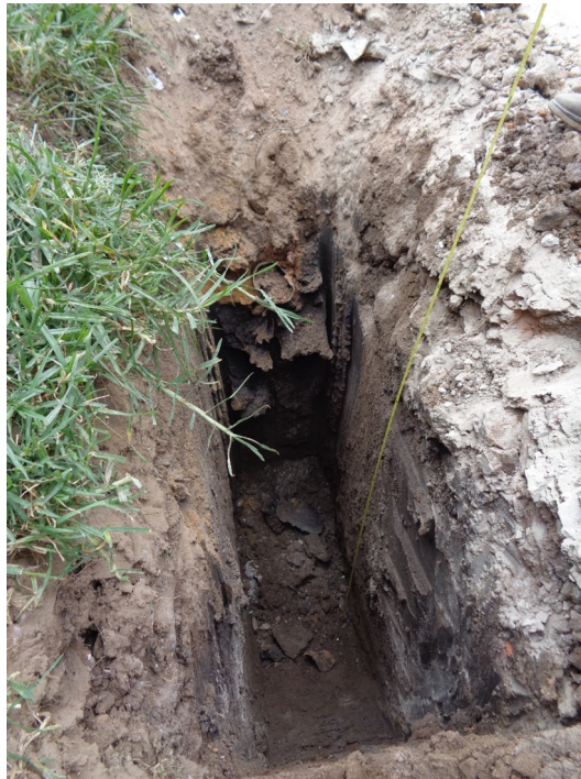
Figura 57. Calicata del suelo arcilloso más desfavorable
