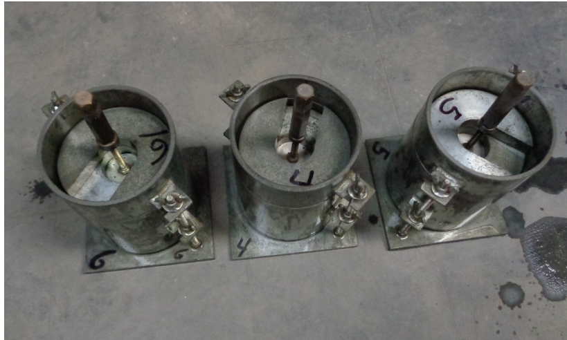
Figura 63. Drenado de moldes del ensayo CBR antes de la prueba de carga – penetración
