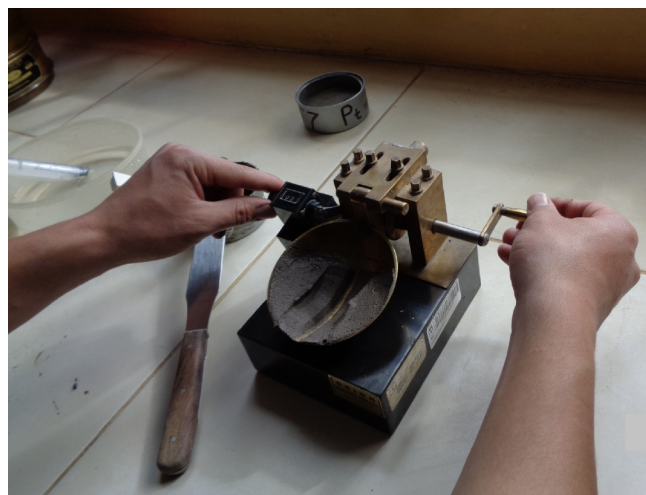
Figura 60. Ensayo de Límite Líquido de la muestra de suelo
