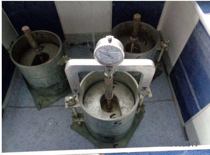
Figura 62. Proceso de saturación de la muestra en el ensayo CBR
