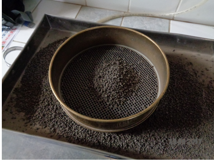
Figura 61. Muestra de suelo para los ensayos de Proctor modificado y CBR
