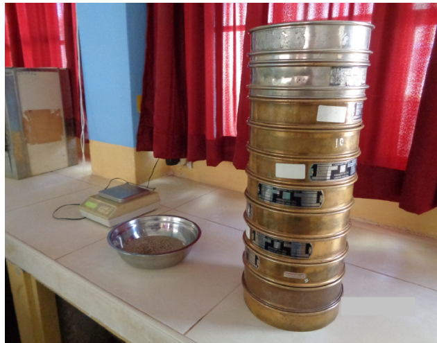
Figura 59. Ensayo de análisis granulométrico de la muestra de suelo
