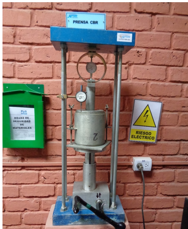
Figura 64. Prueba de carga – penetración en el ensayo CBR
