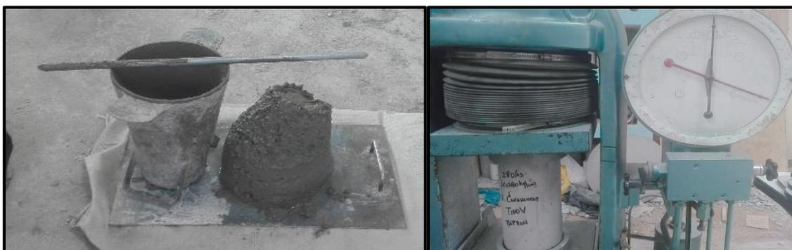
*Figura N°13:* Ensayo de consistencia y resistencia a compresión.
