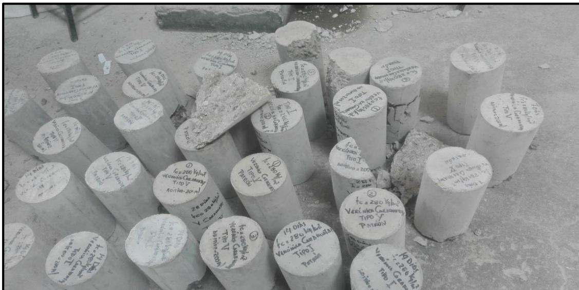
**Figura N°36:** Fallas típicas obtenidas en los especímenes ensayados a compresión
