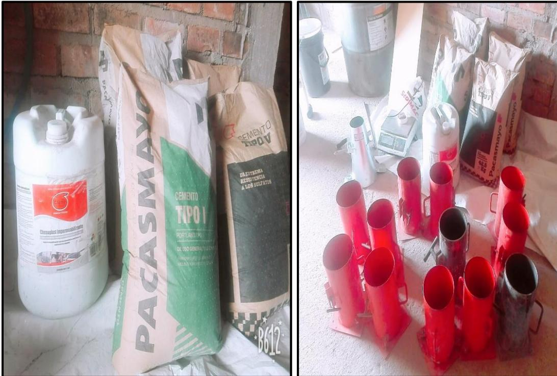
*Figura N°28: Materiales utilizados para el diseño de mezclas: cemento, aditivo, moldes cono de Abrams, varilla y balanza, entre otros.*
