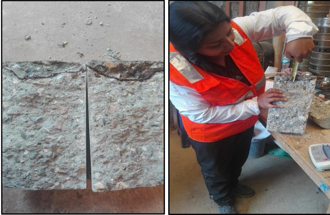
*Figura N°41: Medición de la penetración del agua en el espécimen.*
