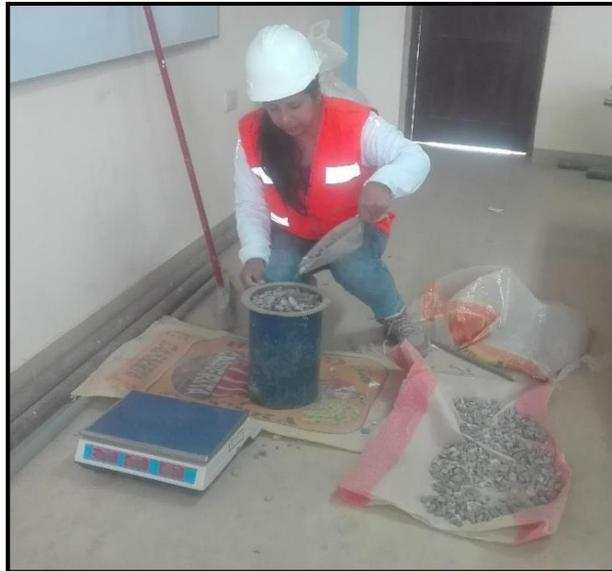
*Figura N°4: Ensayo de peso unitario compactado del agregado grueso.*
