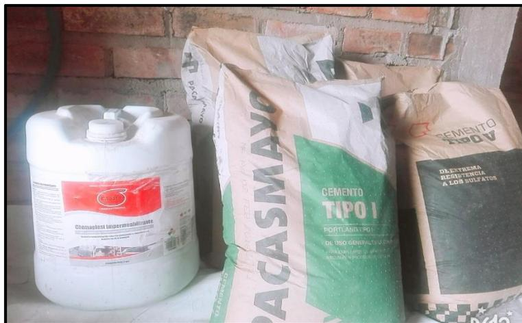
**Figura N°14:** Aditivo Chemaplast Impermeabilizante, Cemento Pacasmayo Tipo I y V.
