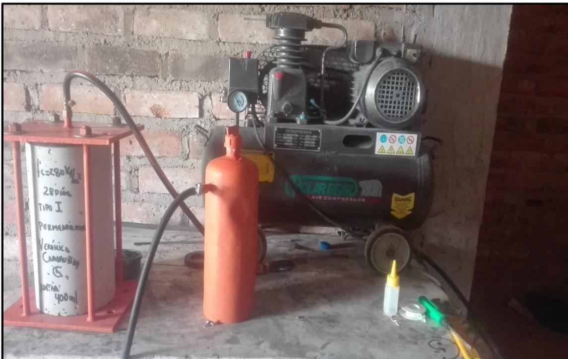
*Figura N°38: Equipo de penetración para realizar el ensayo de permeabilidad.*
