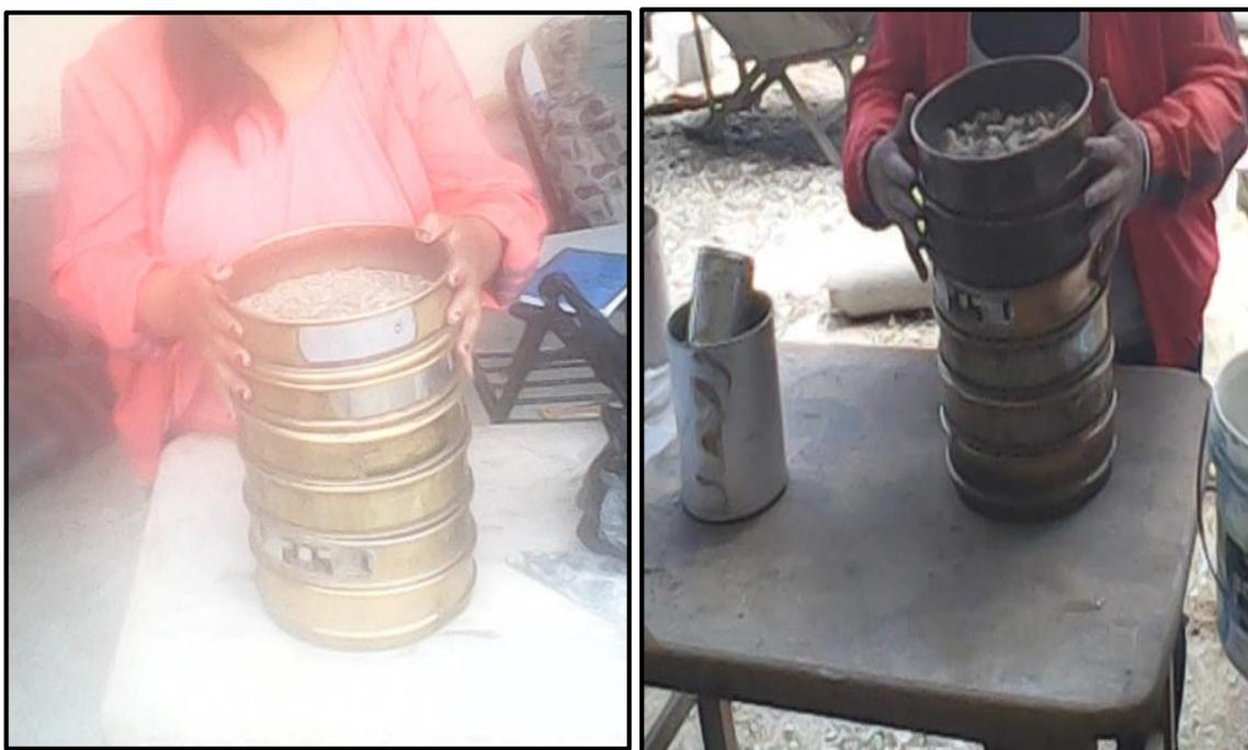
*Figura N°21: Tamizado del agregado tanto fino como grueso para la obtención de su
