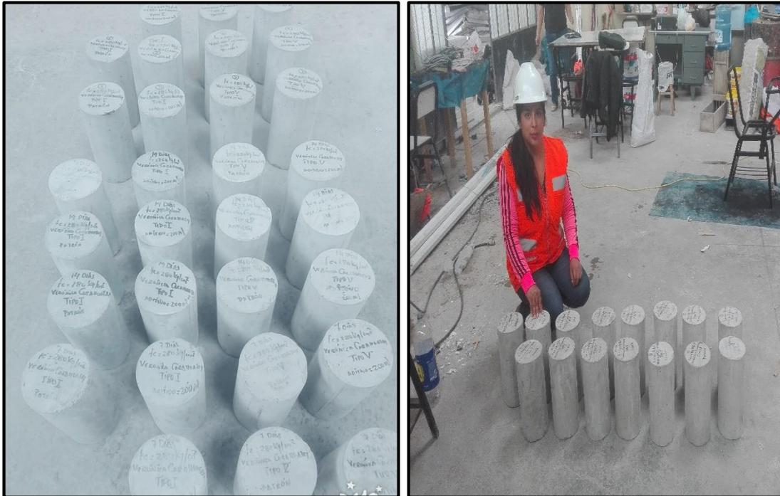
**Figura N°34:** Identificación, pesado, y medición de los especímenes para su posterior rotura.
