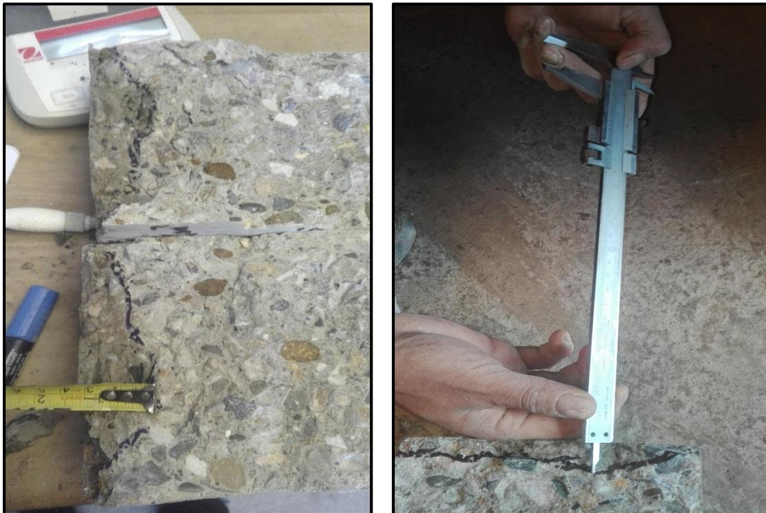
*Figura N°42: Se hizo las medidas necesarias de cada espécimen para el ensayo de penetración, y lograr así una mejor precisión.*
