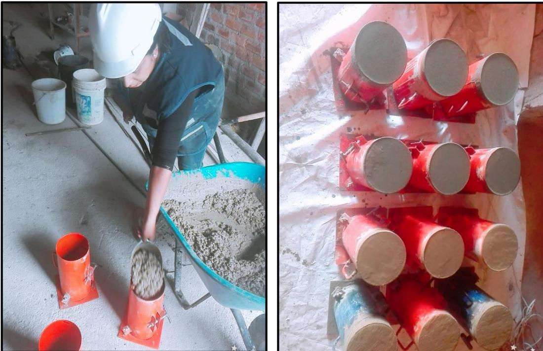
*Figura N°31: Elaboración de los especímenes de concreto, para los ensayos de compresión.*
