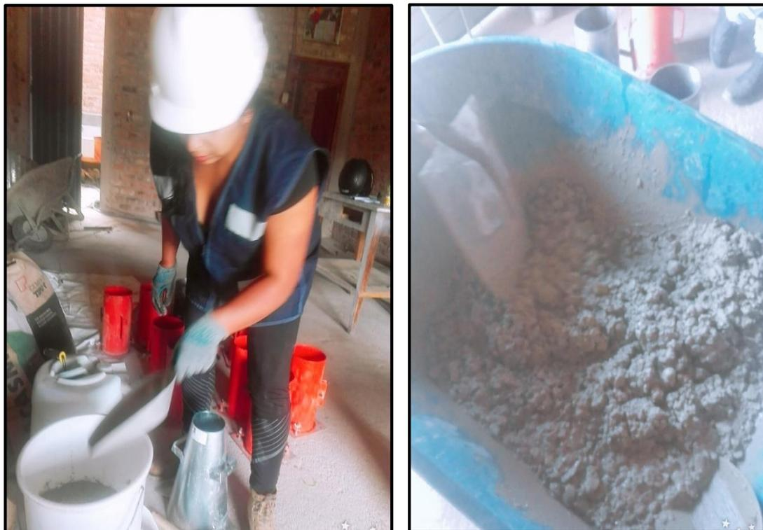
*Figura N°29: Pesando y mezclando cada uno de los materiales del diseño para el concreto patrón.*
