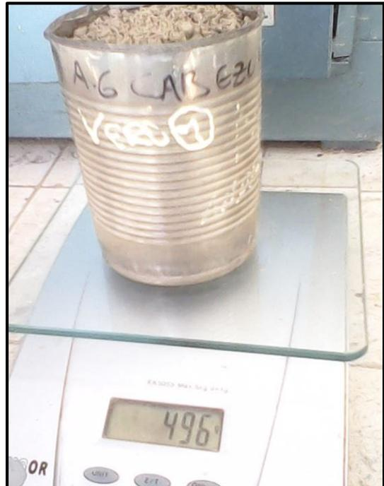
*Figura N°22: Secado al horno por 24 horas, se tomó datos para obtener el contenido de humedad.*
