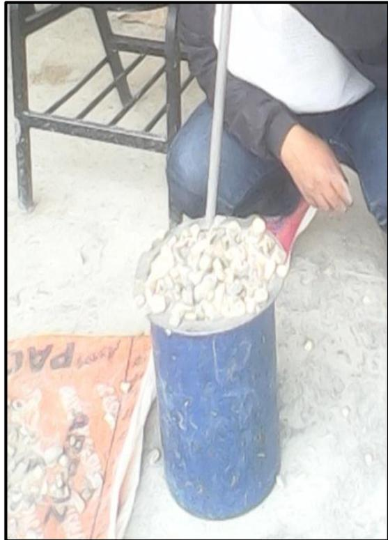
**Figura N°24:** Ensayo de peso unitario seco suelto y compactado del agregado grueso.
