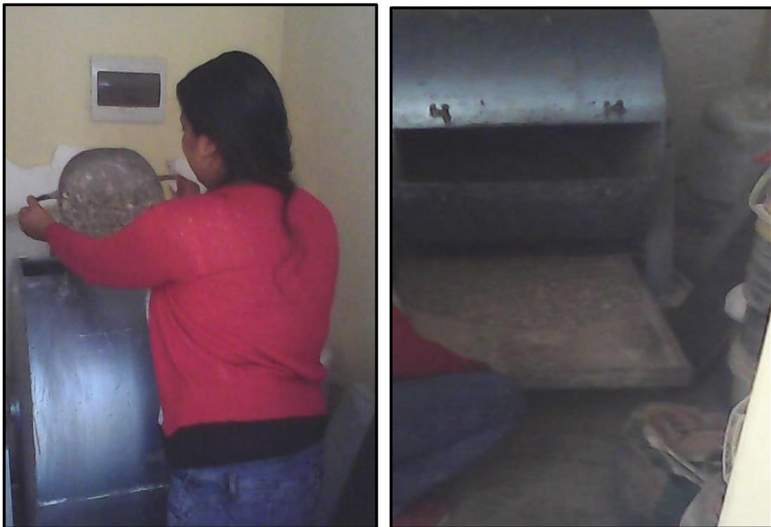
*Figura N°27: Ensayo de abrasión en la maquina los Ángeles.*
