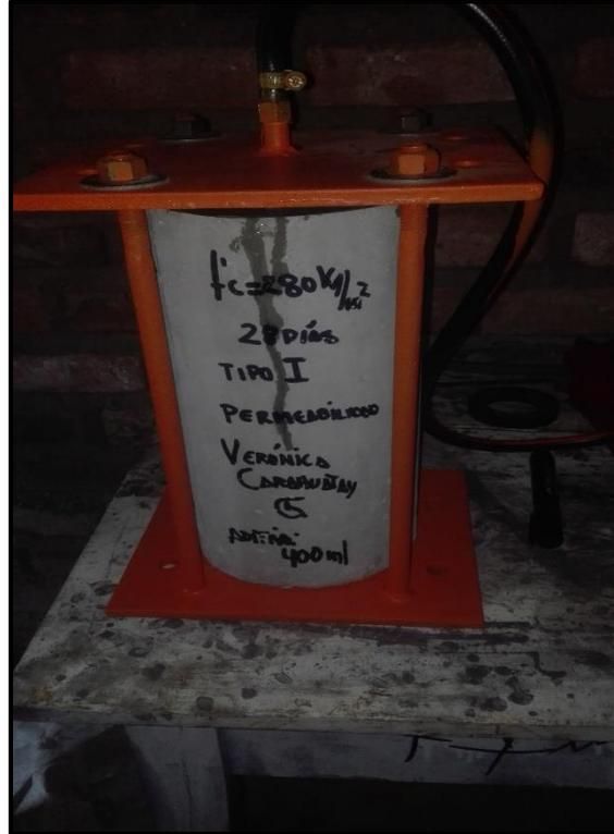
*Figura N°39: Se reguló la presión necesaria de 500 kPa en la compresora para hacer el ensayo de penetración del espécimen.*
