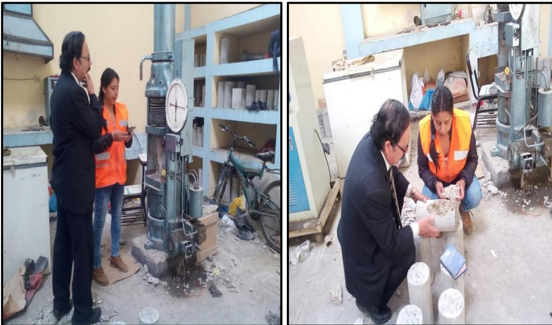
**Figura N°35:** Con el apoyo de mi asesor de tesis **M.en I. Héctor Albarino Pérez Loayza**, se realizó la rotura del espécimen usando el deformímetro y se observó que el agregado grueso no ha sido afectado solo la pasta del concreto.
