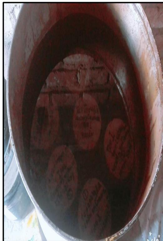
**Figura N°33:** Se muestra los especímenes de concreto con aditivo tanto en estado endurecido, y luego ser curados a los 7, 14 y 28 días.
