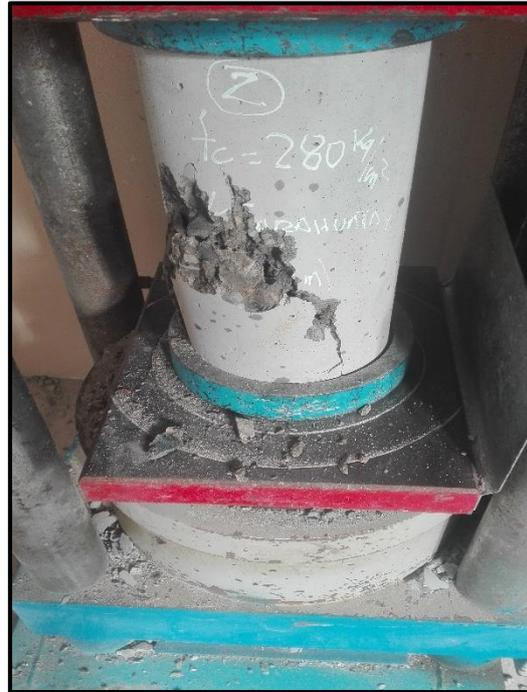
**Figura N°43:** Comprobación del diseño de mezclas en el laboratorio de la UNC, junto al Ing. José Lázaro Lezama Leiva. el cual se verificó variaciones en los resultados obtenidos.
