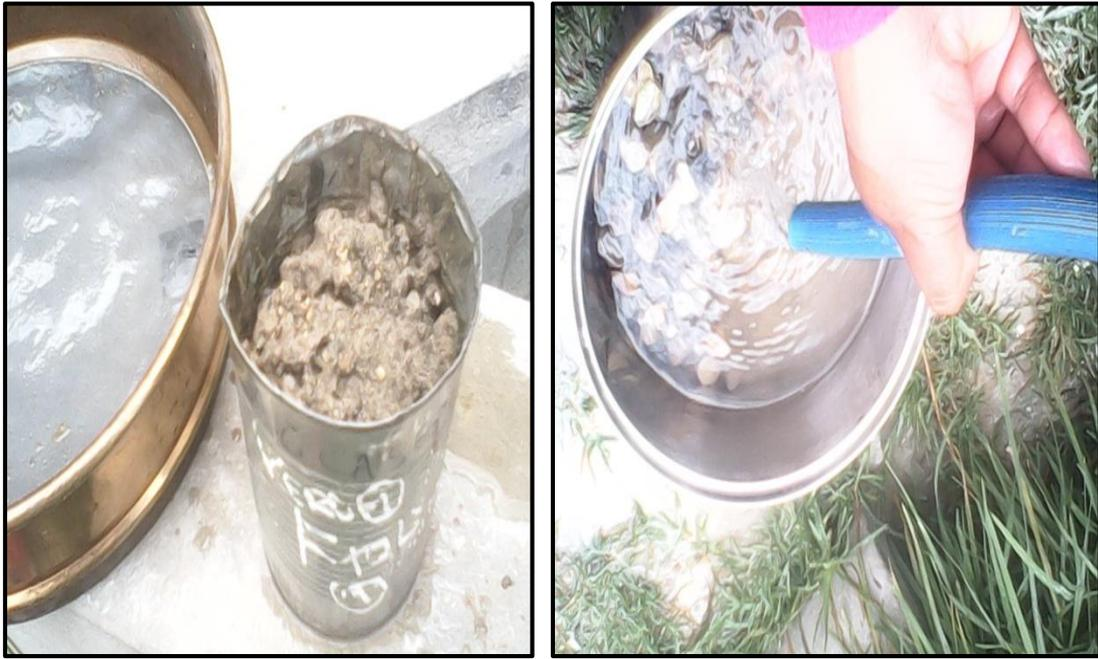
*Figura N°26: Ensayo de lavado del agregado para determinar las partículas que pasan el tamiz N° 200.*
