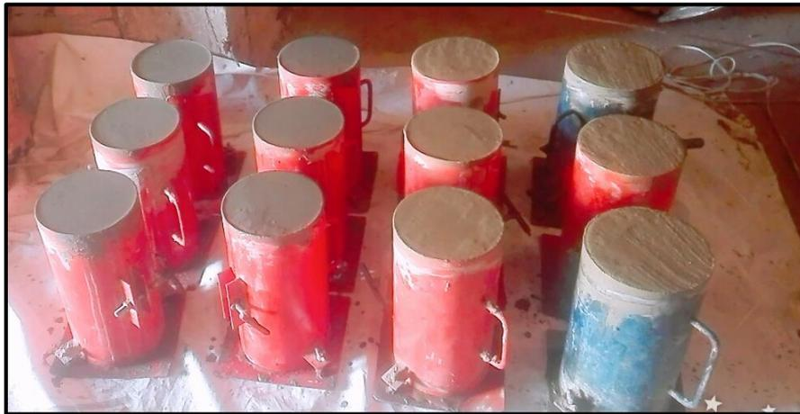
*Figura N°16: concreto en estado fresco.*
