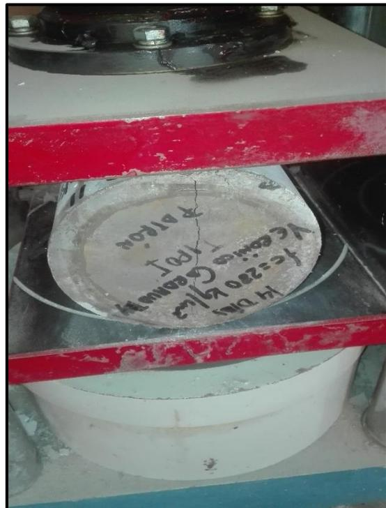
*Figura N°40: Colocación del espécimen de concreto en la máquina de compresión, para realizar el ensayo con el espécimen a tracción indirecta.*
