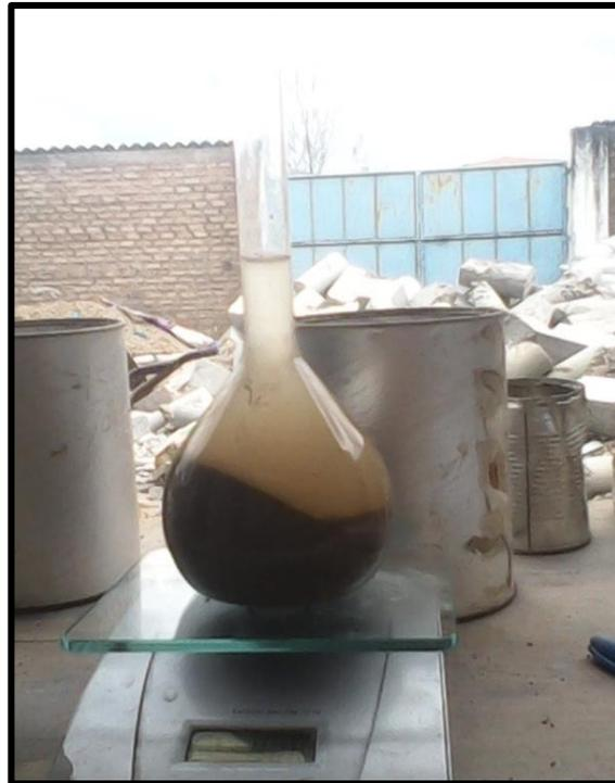
**Figura N°3:** *Ensayo de peso específico del agregado fino.*
