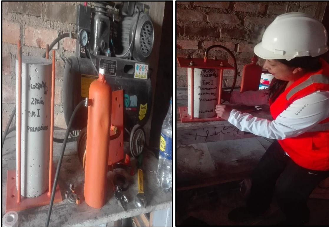
*Figura N°37: Colocando la probeta para realizar el ensayo de penetración de agua para el ensayo de permeabilidad.*
