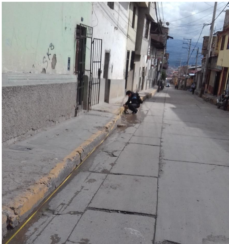
Foto 20: Medida de la longitud de calzada Jr. José Gálvez (Sullana – Av. Perú y Aforo Vehicular - Estación 10)
