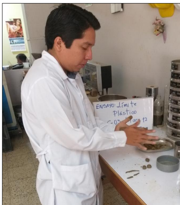
Fotografía 05. Ensayo Límite Plástico Calicata C - 03.
