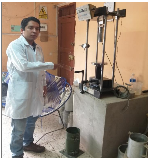
Fotografía 07. Máquina de carga para realizar ensayo CBR
