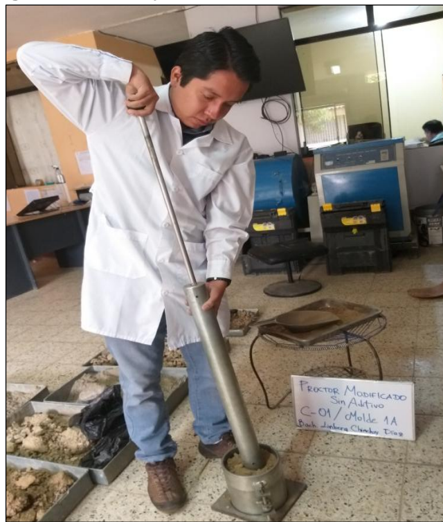
Fotografía 06. Ensayo Proctor Modificado Calicata C - 01.
