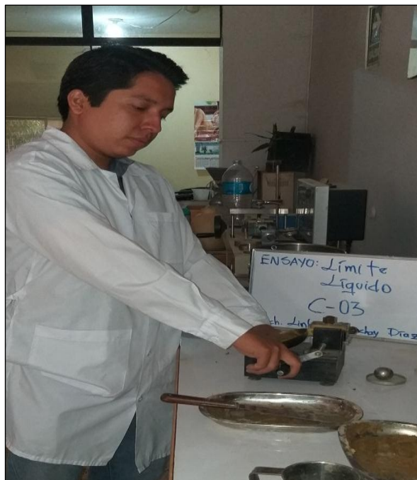
Fotografía 04. Ensayo Límite Líquido Calicata C - 03.
