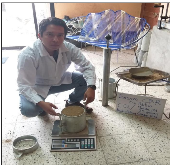
Fotografía 08. Moldes para el ensayo CBR de la calicata C-02.
