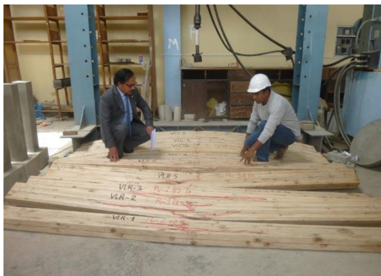
Fotografía N° 24. Comparacion de fallas en vigas ensayadas.
