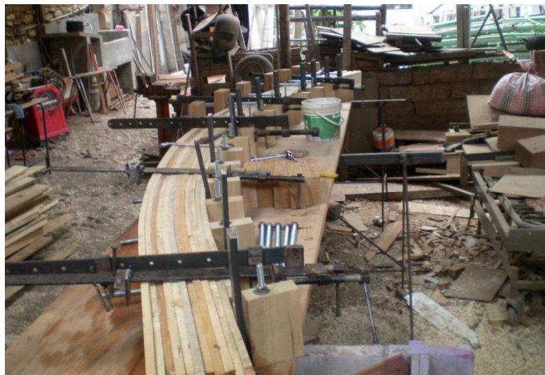
Fotografía N° 12. Prensado de láminas para elaboracion de vigas laminadas en arco.
