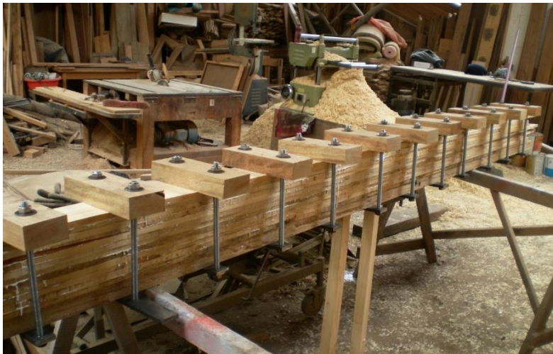
Fotografía N° 12. Prensado de láminas para elaboracion de vigas laminadas en arco.
