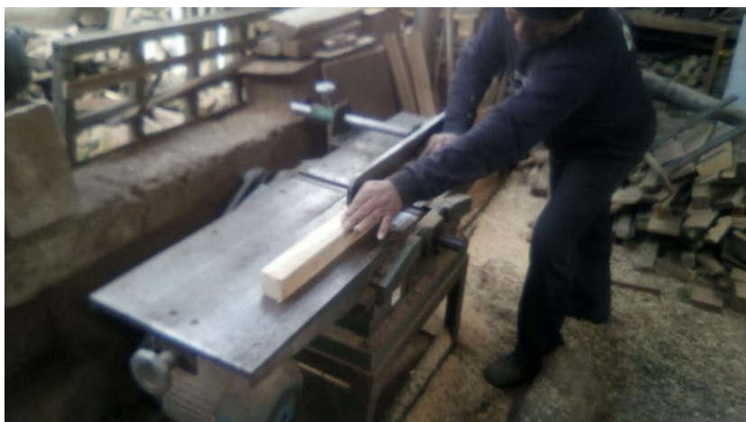
Fotografía N° 6. Habilitación de probetas estándar de flexión
