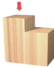
Figura N° 6 Esquema de ensayo de corte simple paralelo a la fibra.
