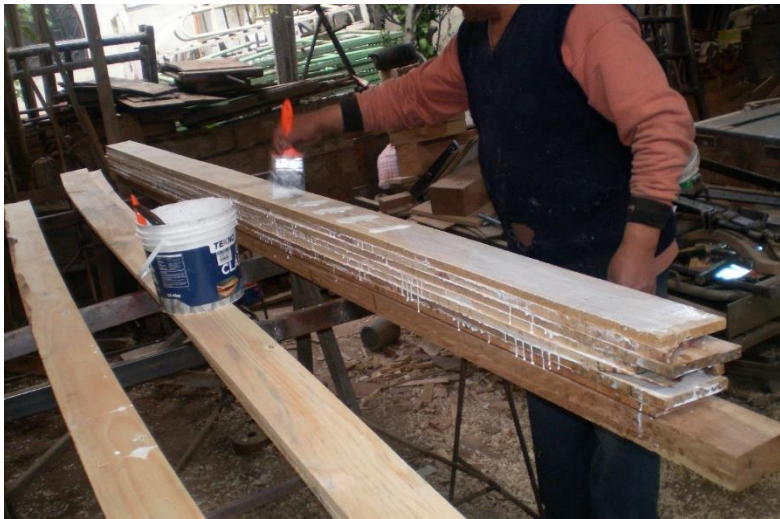
Fotografía N° 11. Prensado de láminas para elaboracion de vigas laminadas rectas.
