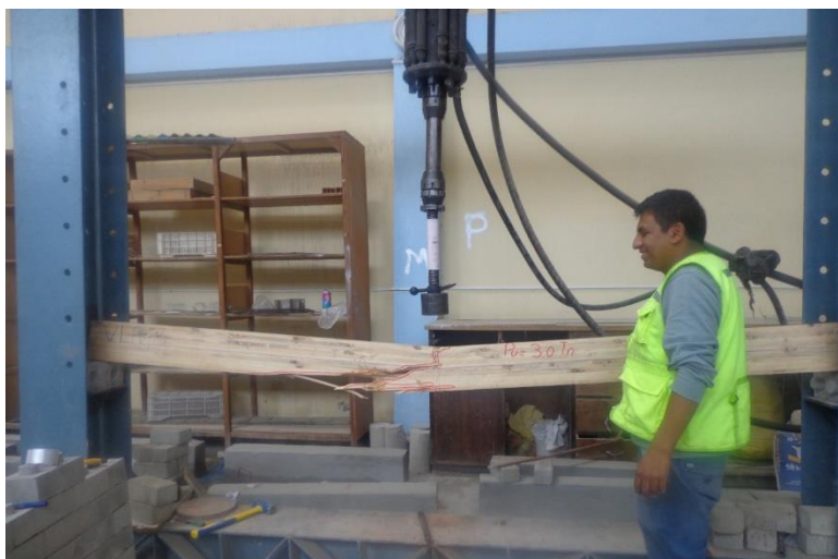
Fotografía N° 21. Ensayo de vigas laminadas rectas
