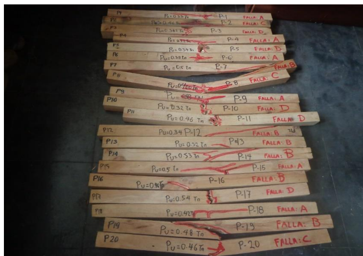
Fotografía N° 18. Probetas de flexion ensayadas.
