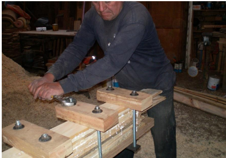
Fotografía N° 14. Reapriete de prensas en la elaboración de viga laminada en arco.
