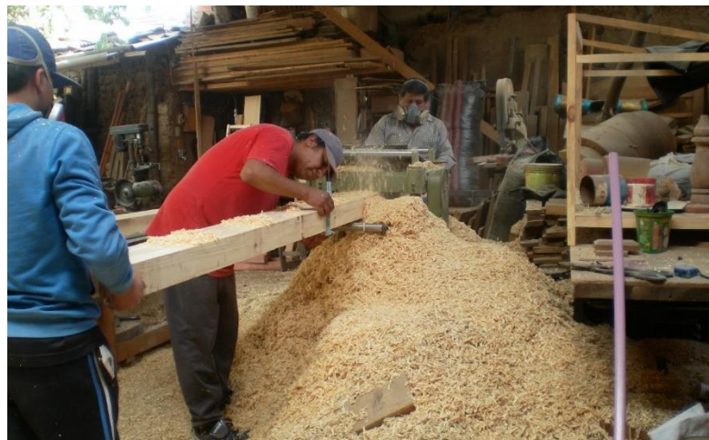
Fotografía N° 15. Cepillado final de vigas laminadas rectas.
