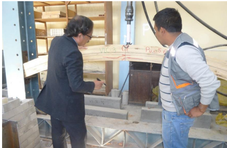
Fotografía N° 24. Comparacion de fallas en vigas ensayadas.
