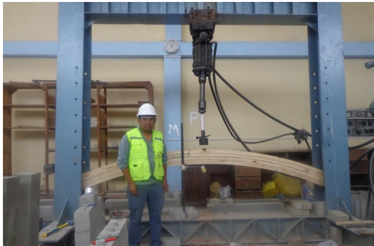
Fotografía N° 23. Estudio de falla en viga laminada en arco.
