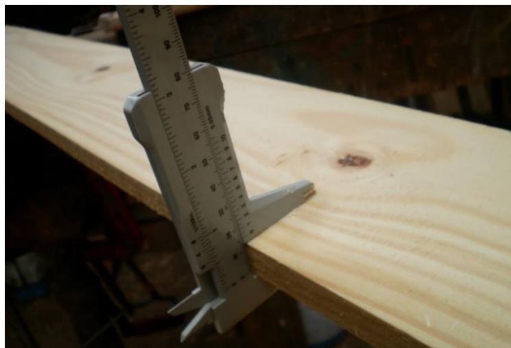
Fotografía N° 9. Control de espesor de laminas cepilladas
