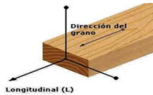
Figura N° 3. Eje axial o longitudinal de la madera.
