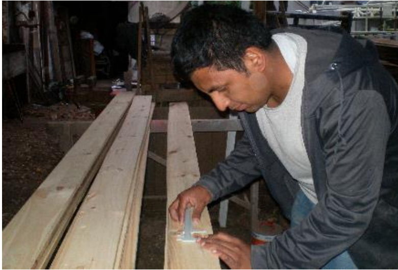
Fotografía N° 8. Cepillado de láminas
