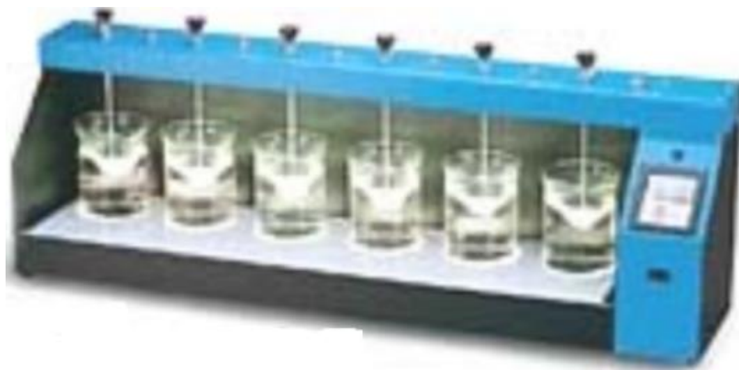
Figura N° 03 Aparato agitador para la prueba de jarras con iluminación de la base
