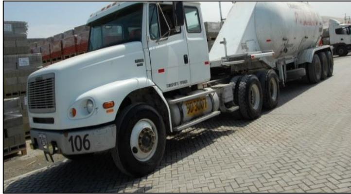
Figura N° 8: La rugosidad permite un mejor frenado a los vehículos. Fuente: (Pacasmayo, Adoquines de concreto Pacasmayo, 2010)
