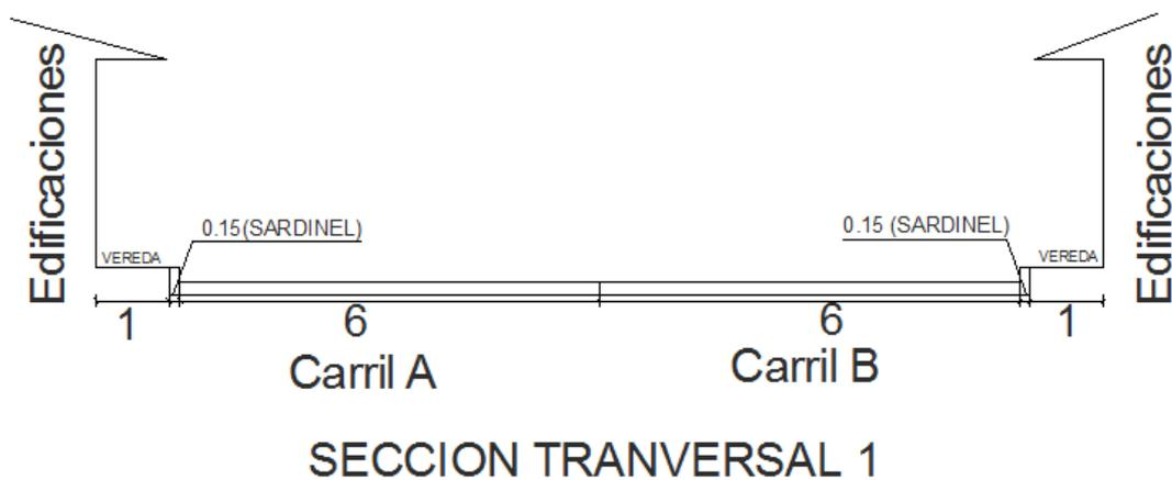
Figura 28. Detalle de la sección transversal 2 del pavimento rígido estudiado.
