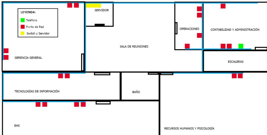
Fig. 28: Plano de Red Segundo Nivel de las Oficinas Deyfor E.I.R.L.
