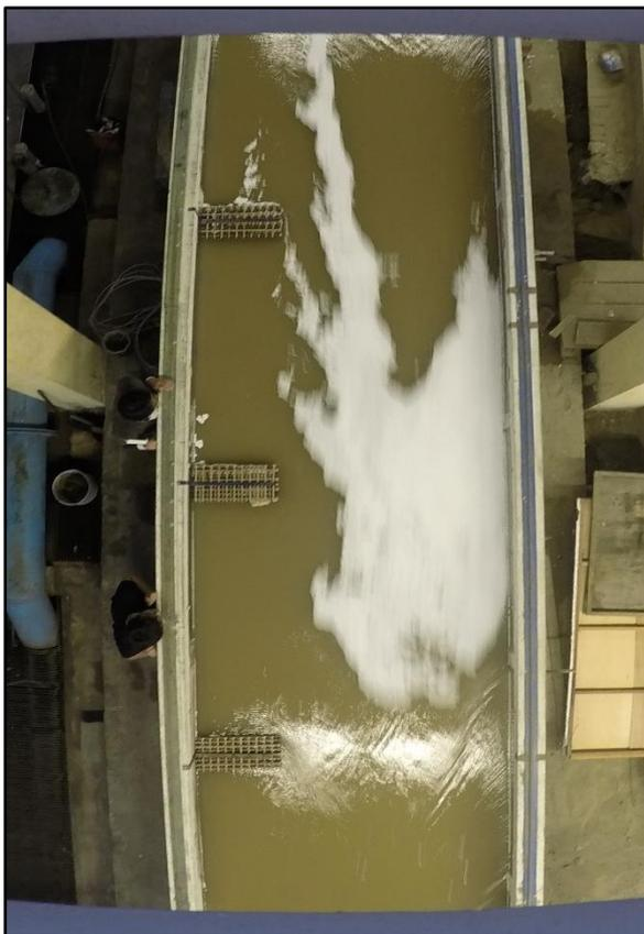
Figura 40: Vista en planta de las partículas de baja densidad, para el ensayo con estructuras de 26% de permeabilidad.
