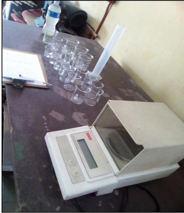
Figura 85: probeta, vasos de pírax y balanza electrónica de precisión utilizados para obtener la concentración de sedimentos en suspensión
