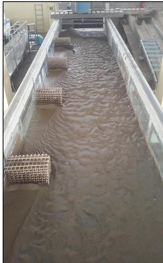
*Figura 49: Vista general de la erosión en las estructuras de 26% de permeabilidad.*
