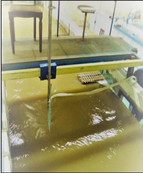
Figura 83: Sistema de evacuación de muestra de sedimentos en suspensión.
