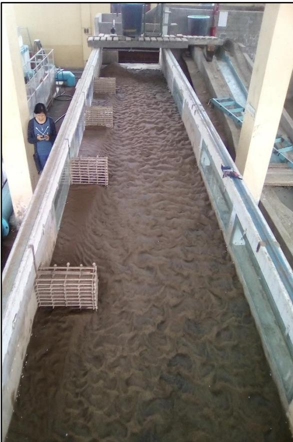
*Figura 48: Vista general de la erosión en las estructuras de 46% de permeabilidad.*
