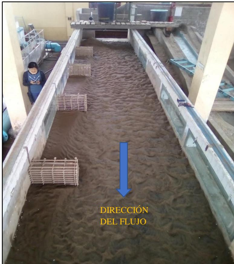
Figura 71: Vista panorámica del canal experimental utilizado, después de un ensayo típico
