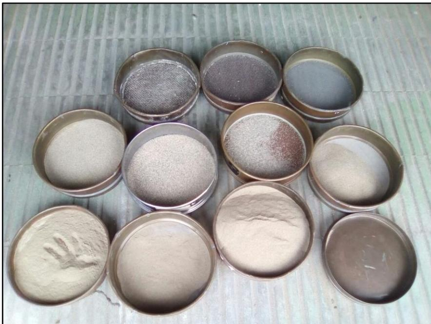
Figura 90: Análisis granulométrico del material de fondo a utilizar durante la etapa experimental
