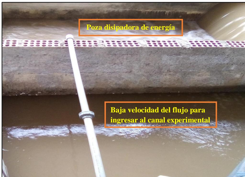
Figura 77: Funcionamiento de los disipadores de energía en la entrada del canal, durante los ensayos experimentales.
