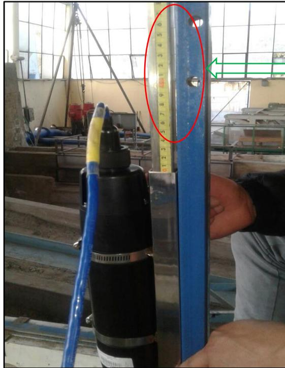
Cinta métrica ubicada en el soporte del Vectrino para regular las alturas de medición de velocidades a lo largo de la columna de agua.
