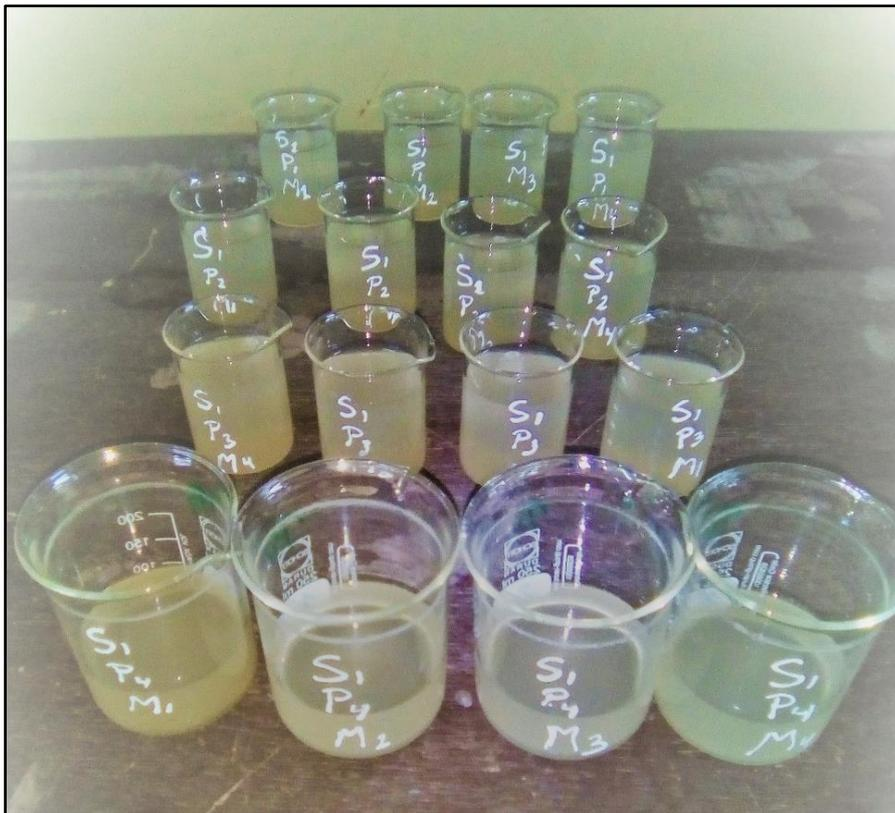
Figura 88: Medición de un volumen de 100 ml de muestra de sedimentos en suspensión
