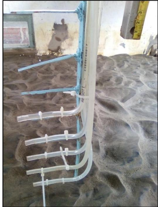
Figura 82: Mangueras de 3/8" de diámetro ubicadas cada 5 cm verticalmente.
