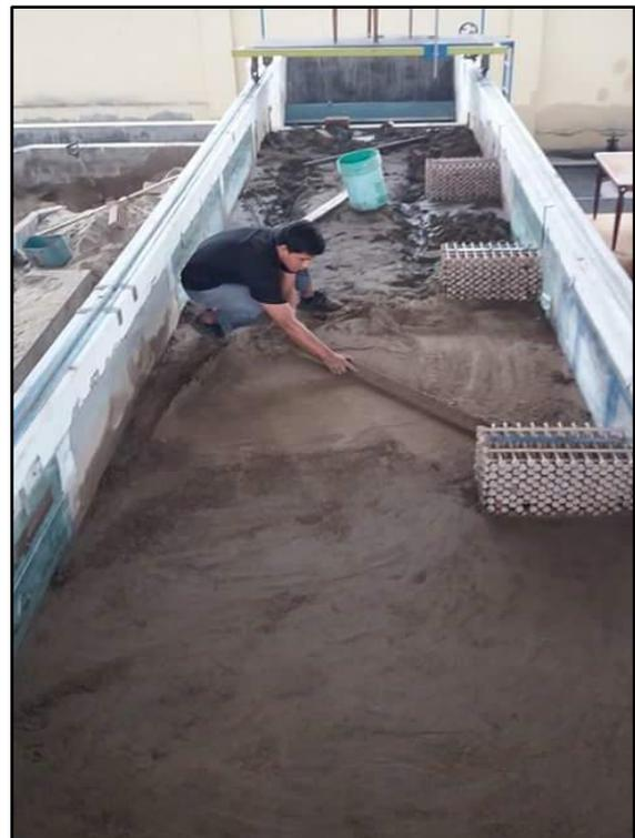
Figura 80: Nivelación del lecho de arena, a través de un regleado cada 0.5 m
