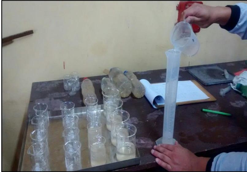
Figura 87: Medición de un volumen de 100 ml de muestra de sedimentos en suspensión
