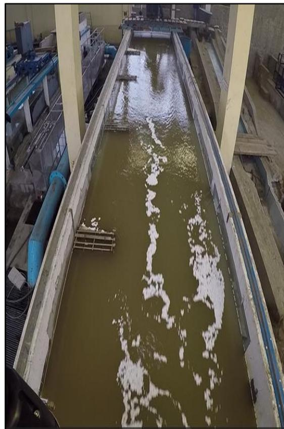
Figura 41: Vista en planta de las partículas de baja densidad, para el ensayo con estructuras de 46% de permeabilidad
