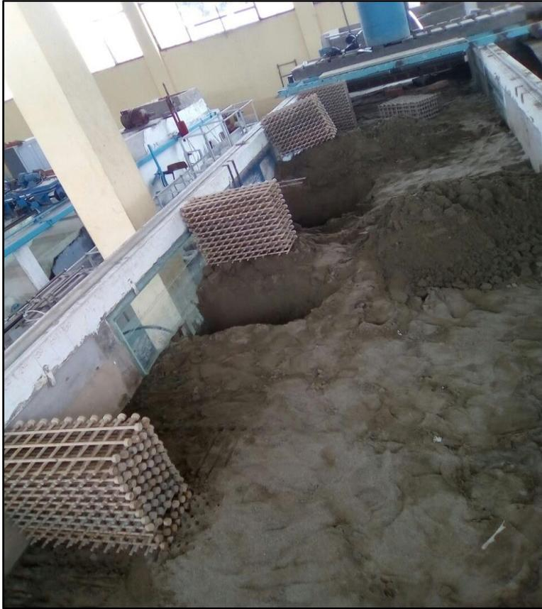
Figura 89: Instalación de los espigones en la margen derecha del canal experimental
