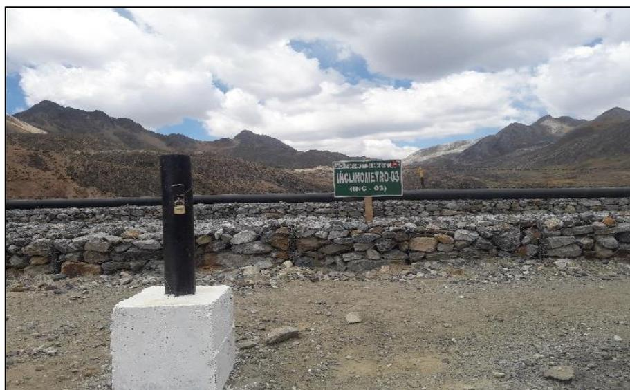
Foto 8. Inclinómetro INC-03 instalado.
