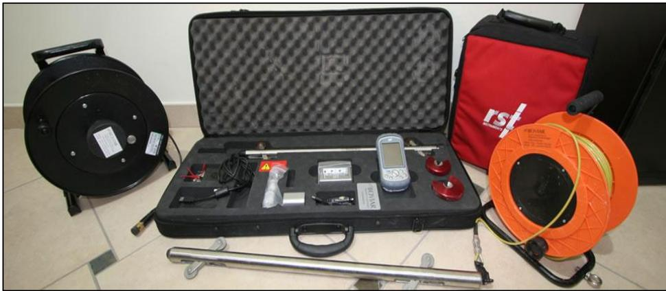
Figura 3. Inclínómetro. (Geoinstruments, 2017)
