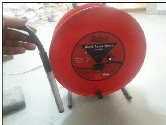
Foto 7. Sonda eléctrica adquirida por SMCSA
