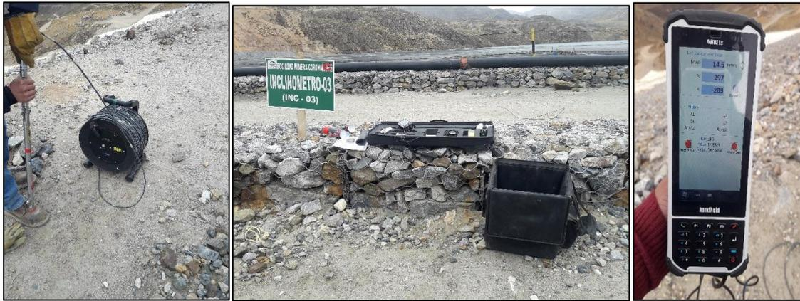
Foto 9. Equipo inclinométrico – adquirido de Geokon
