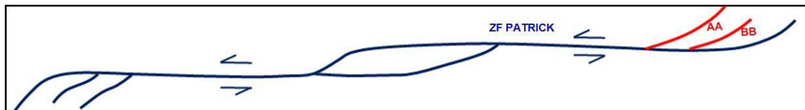
Figura 29. Esquema de un horsetail o cola de caballo de una zona de falla sinistral, evidenciando el posible esquema de formación de las vetas AA y BB.
