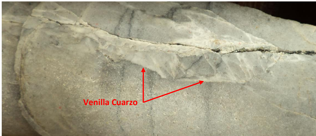
Figura 23: Fotografía de una muestra del sondaje ANT-L1300-01 (222.30m), nótese la presencia de venillas de cuarzo cortando cuarcitas de la formación Chimú.
