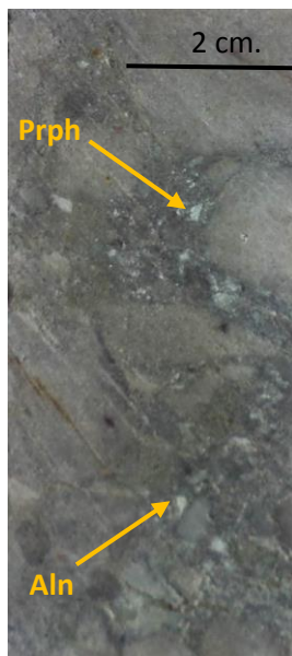
Figura 20: Fotografía de una muestra del sondaje ANT-L1300-01 (45.50m). Nótese la alteración argílica avanzada desarrollada en la matriz de una cuarcita de la Formación Chimú.
