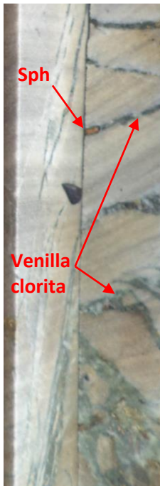
Figura 19: Fotografía de una muestra del sondaje ANT-L1300-01 (267.35m), nótese el grado de alteración en la roca (skarnoide) cortada por venillas de clorita con diseminaciones de Esfalerita dentro de ella.
