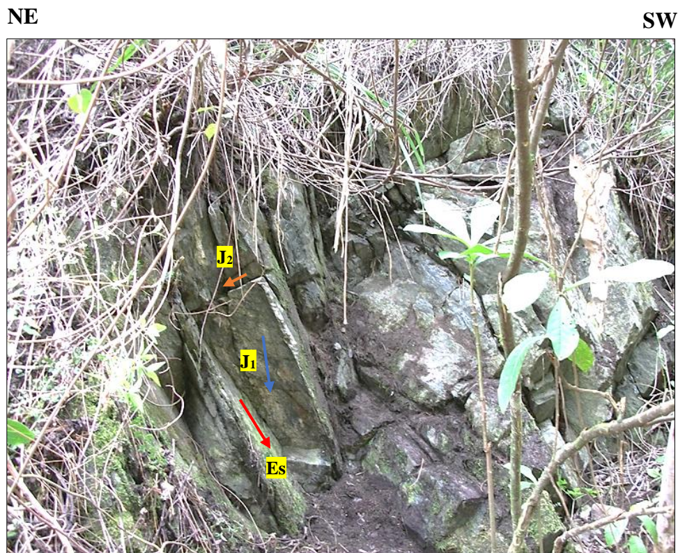
Foto 3.4: Principales familias o sets de fracturas en el macizo esquistoso. Es, esquistosidad ; J 1 y J 2 , juntas principales.
