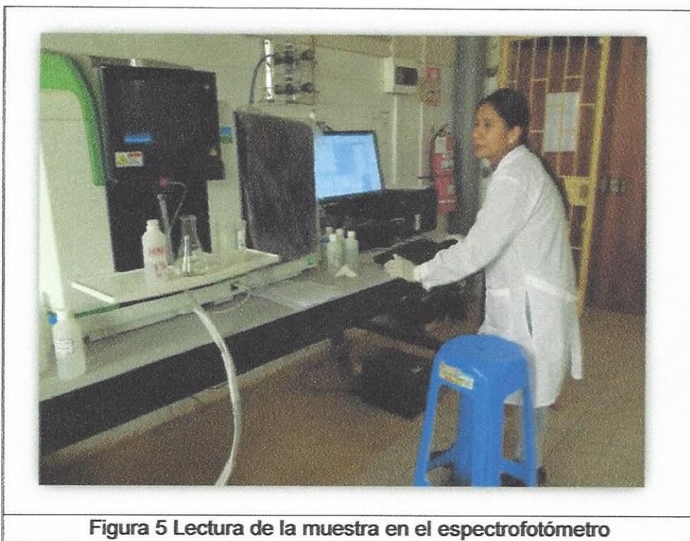
**Figura 5 Lectura de la muestra en el espectrofotómetro**
