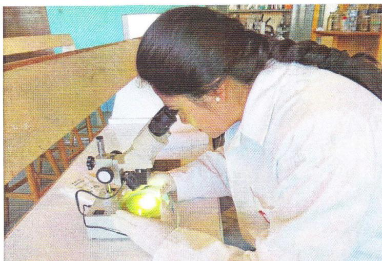
**Fig. 14.** Observación del sedimento en una placa Petri a través del estéreoscopio a 16 aumentos o al microscopio a menor aumento.
