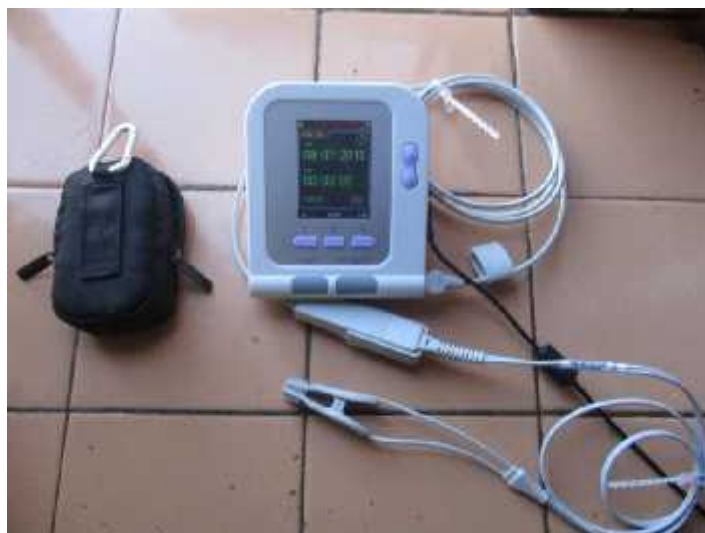
Fig. 1. Pulsioxímetro Digital Eléctrico, con sensor de captación de impulsos y pantalla o monitor.
