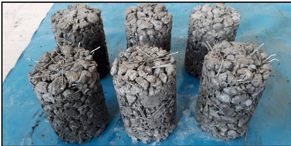
**Figura 75: Especímenes para pruebas de permeabilidad**
