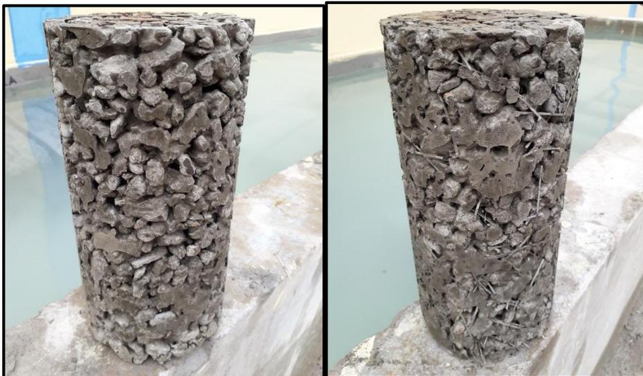
**Figura 85: Especímenes cilíndricos con la adición de nanosilice y fibra de polipropileno trasladados a la poza para su curado**
