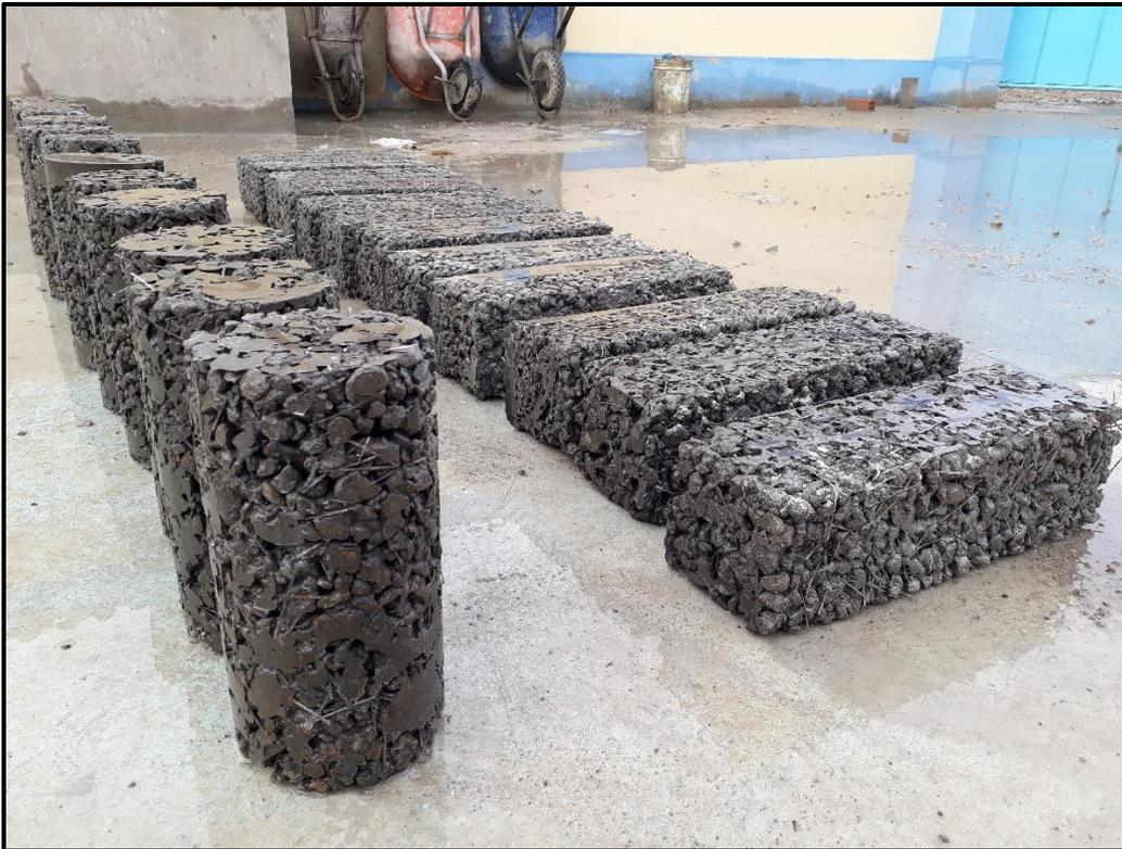
**Figura 93: Especímenes retirados de la poza para someterlos a los ensayos**
