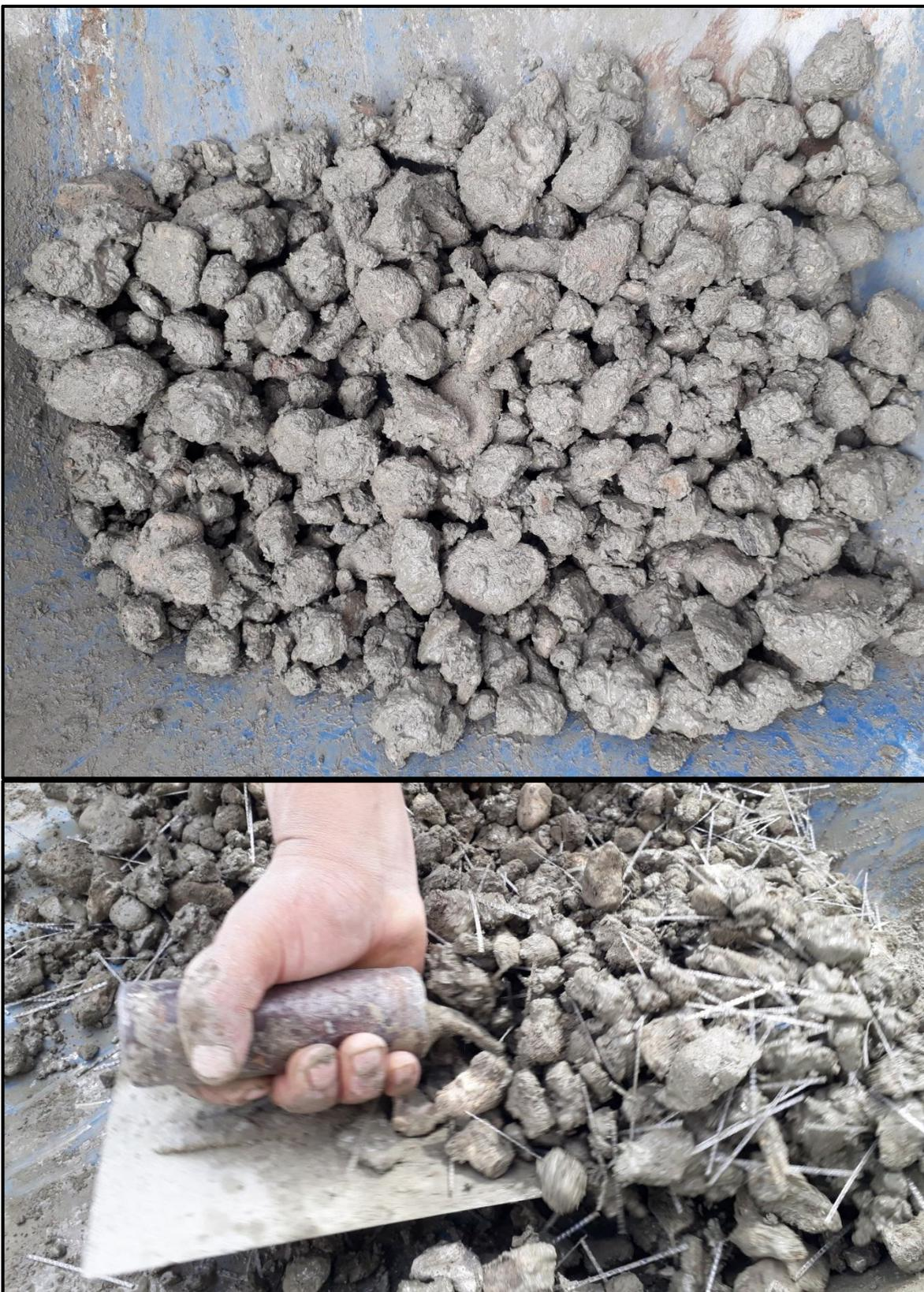
**Figura 59: Pruebas patrones de las 4 dosificaciones a realizadas (sin adiciones, con fibra, con nanosilíce y con la combinación de ambas)**
