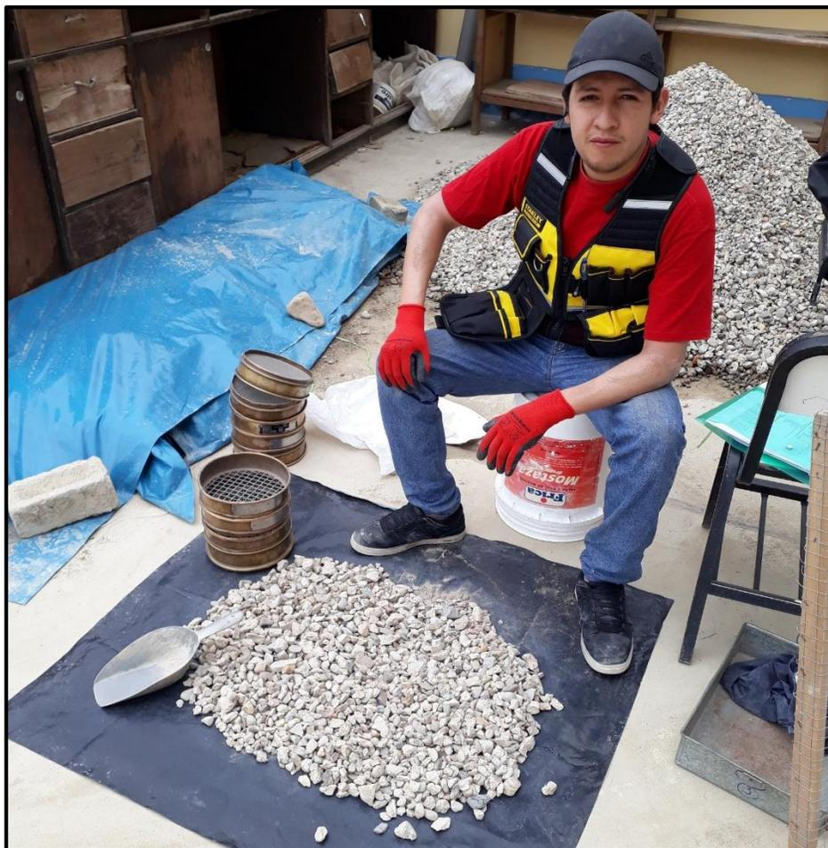
Figura 55: Ensayo de granulometría del agregado
