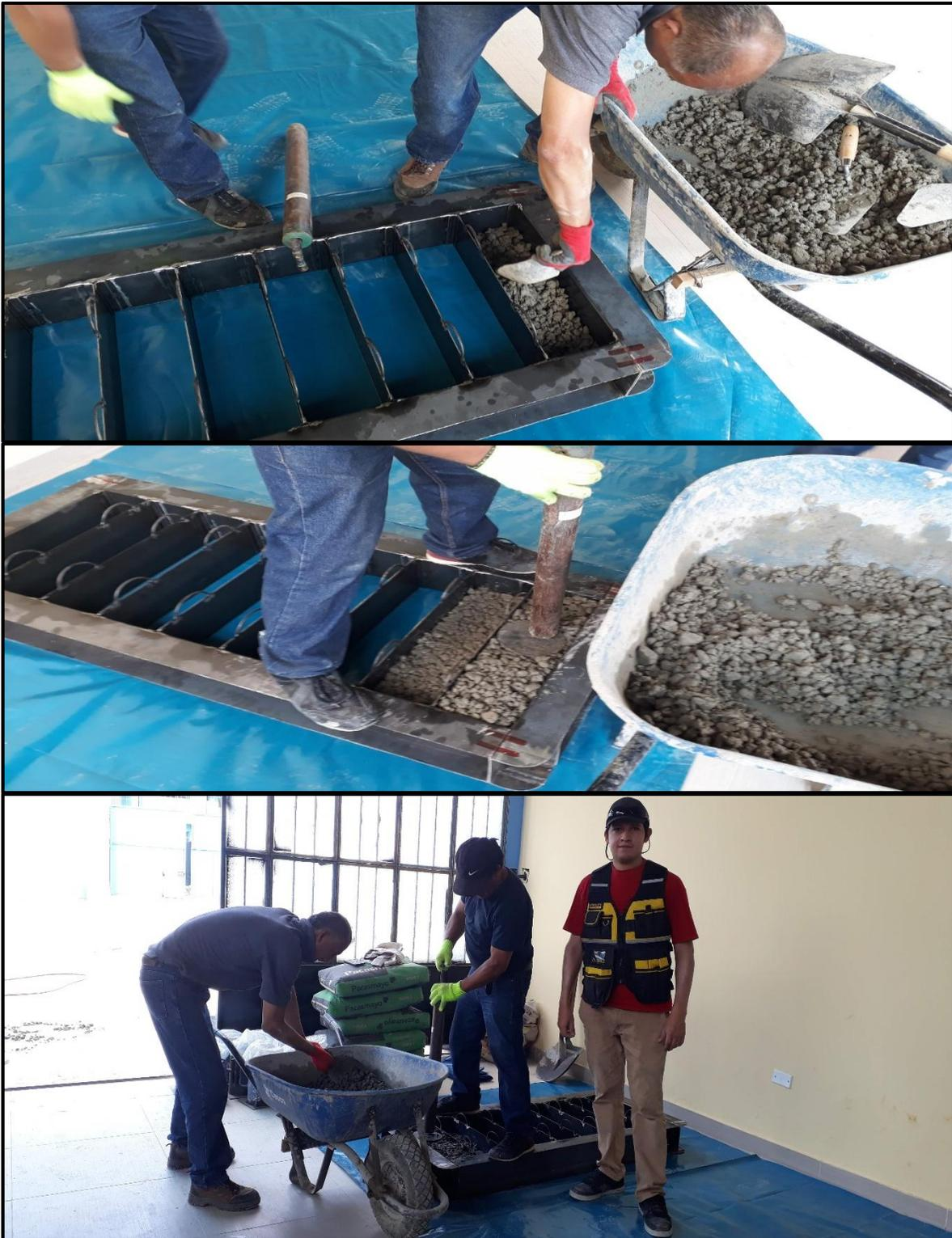
Figura 66: Colocado y compactado de la mezcla en el molde metálico de especímenes prismáticos
