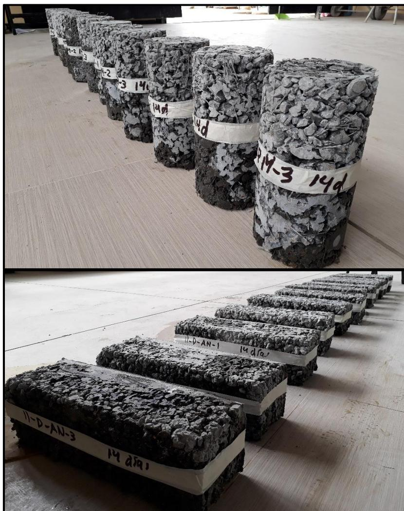
Figura 98: Codificación de muestras para ensayar
