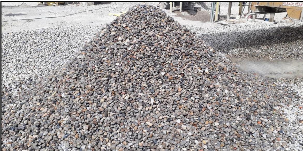
Figura 50: Obtención del agregado grueso proveniente del chancado previo
