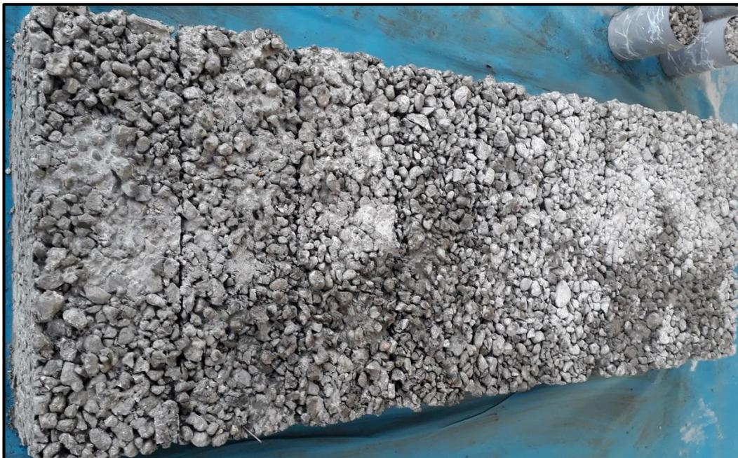
**Figura 81: Especímenes prismáticos elaborados con la adición de nanosílice**
