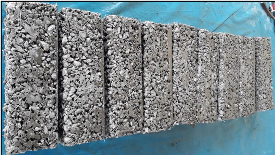
**Figura 83: Especímenes prismáticos elaborados con la adición de nanosílice y fibras de polipropileno**
