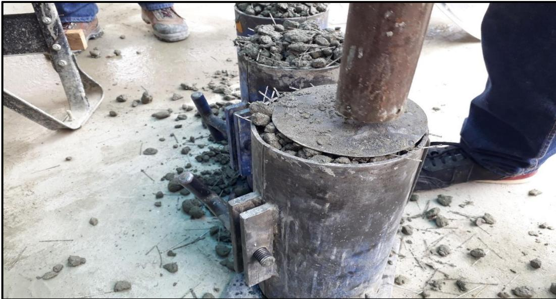
**Figura 70: Compactación de la mezcla con el martillo de proctor modificado**
