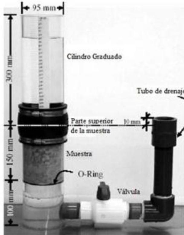
**Figura 18: Equipo de ensayo de permeabilidad recomendado por el ACI 522R-10**
