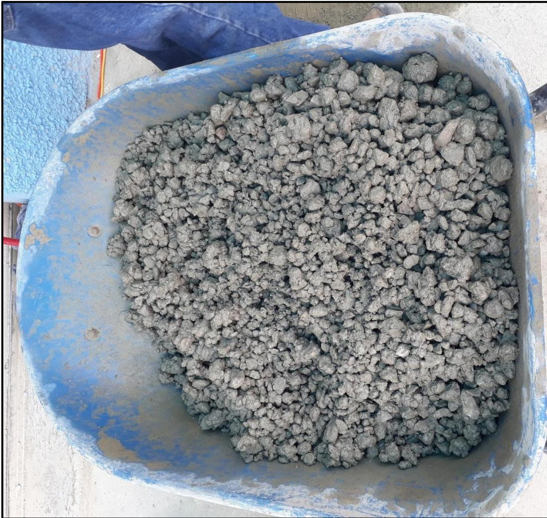
**Figura 67: Consistencia de la mezcla de concreto sin adiciones**
