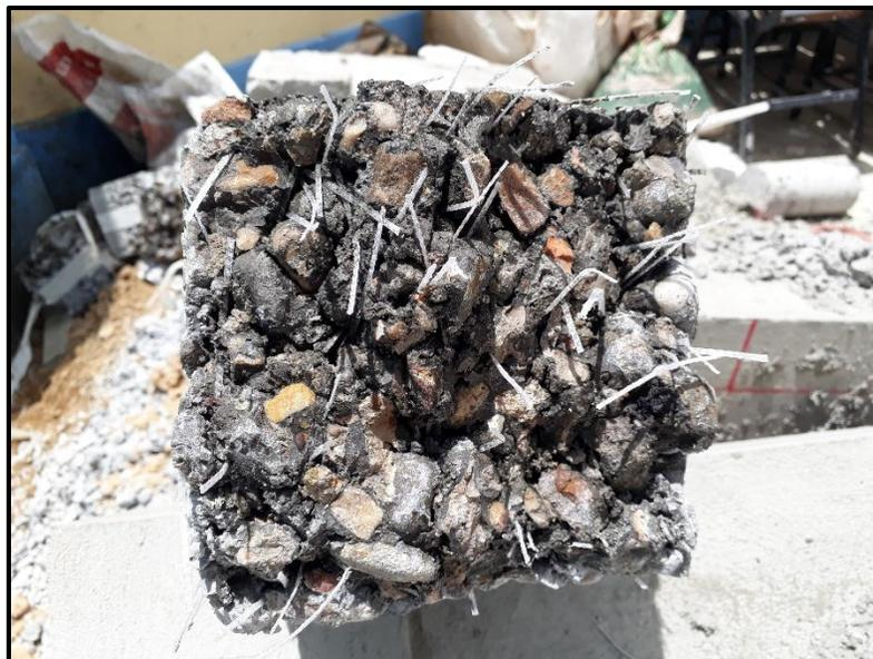
Figura 96: Especímenes de concreto ecológico con fibra de polipropileno después del ensayo a flexión
