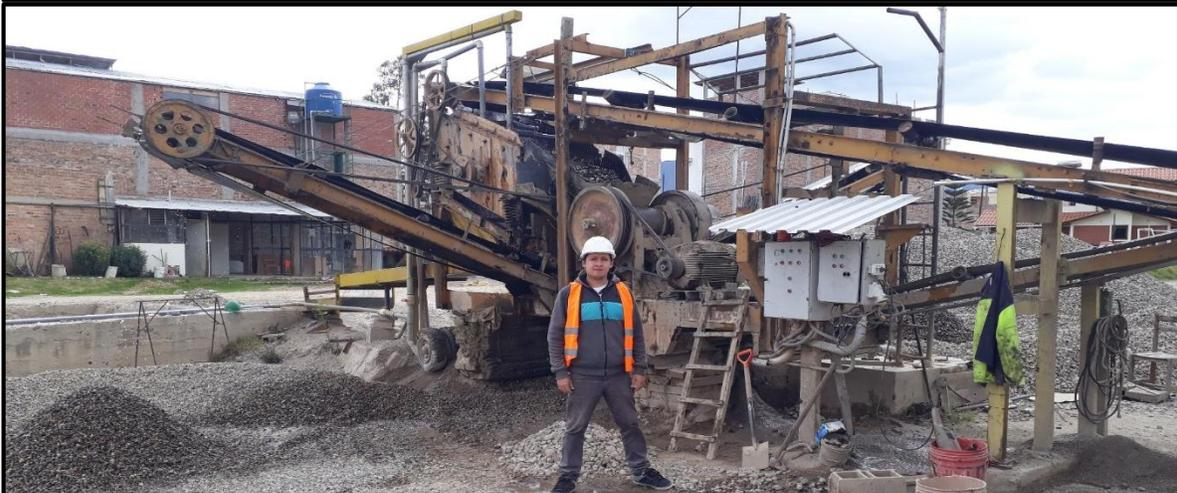
**Figura 49: Proceso de chancado de los bloques de concreto reciclado**
