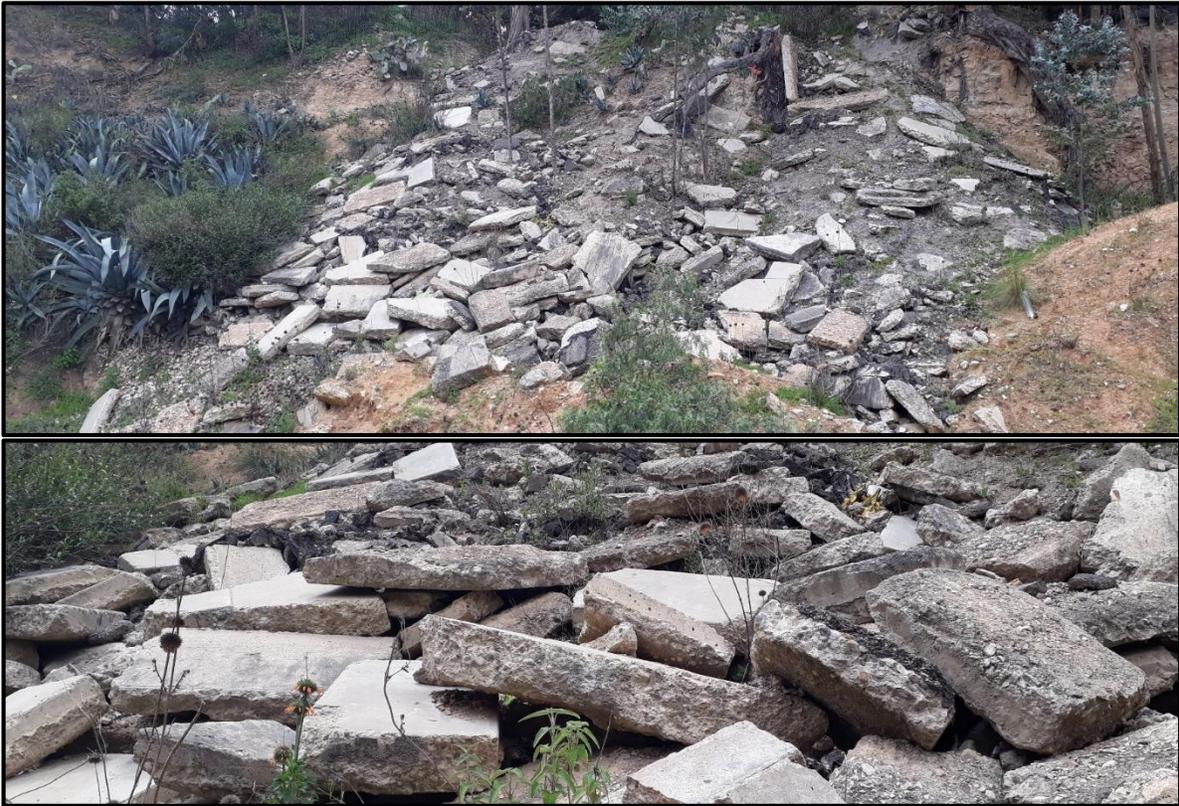
**Figura 44: Botadero de bloques de concreto ubicado en Shudal, de donde se extrajo el agregado grueso**
