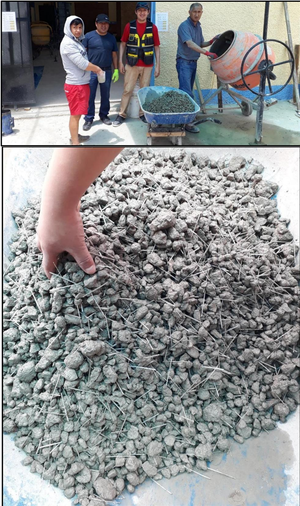
**Figura 69: Consistencia de la mezcla de concreto con fibra de polipropileno**
