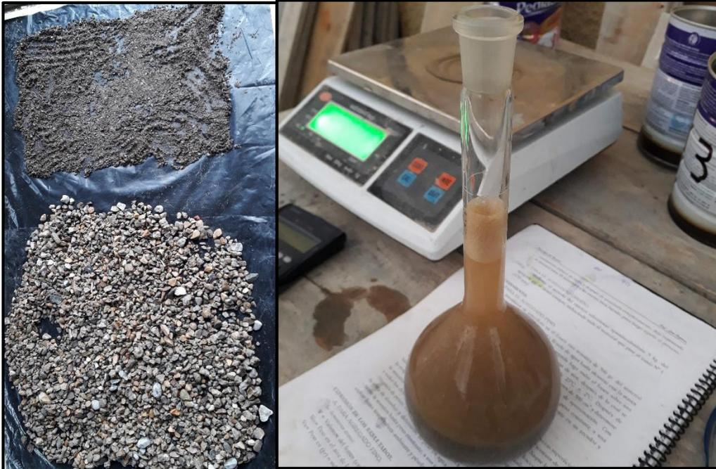
Figura 53: Ensayos para las características físicas de los agregados
