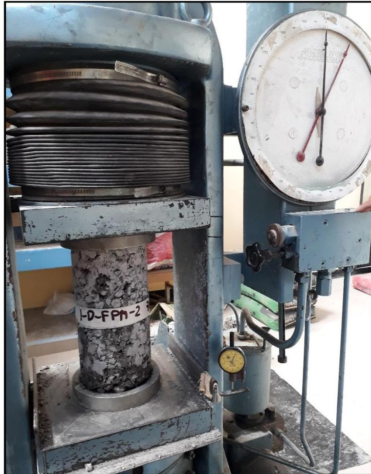
Figura 95: Medición de las deformaciones de los especímenes de concreto ecológico
