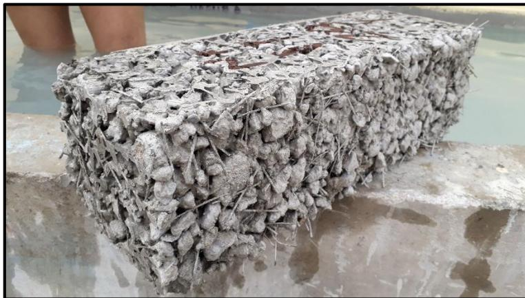
**Figura 86: Especímenes prismático con la adición de nanosilice y fibras trasladado a la poza para su curado**
