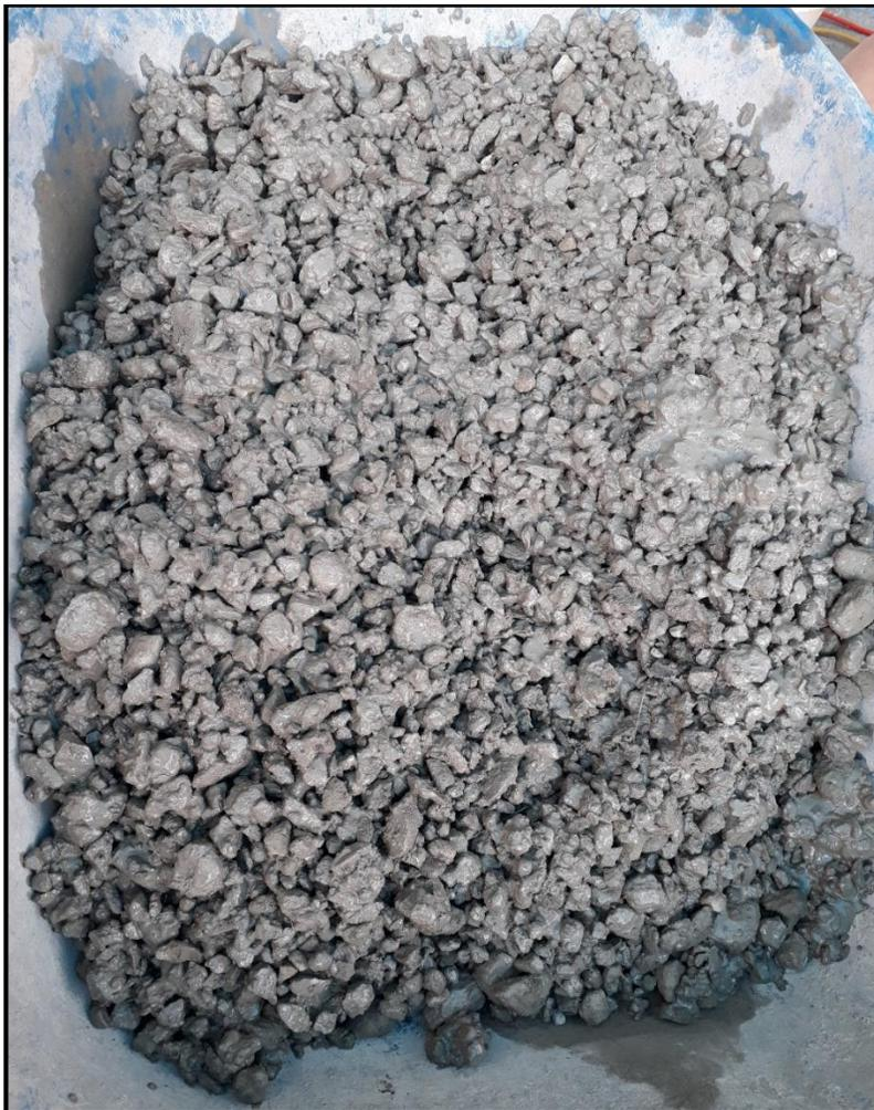
**Figura 76: Consistencia de la mezcla de concreto con nanosílice**
