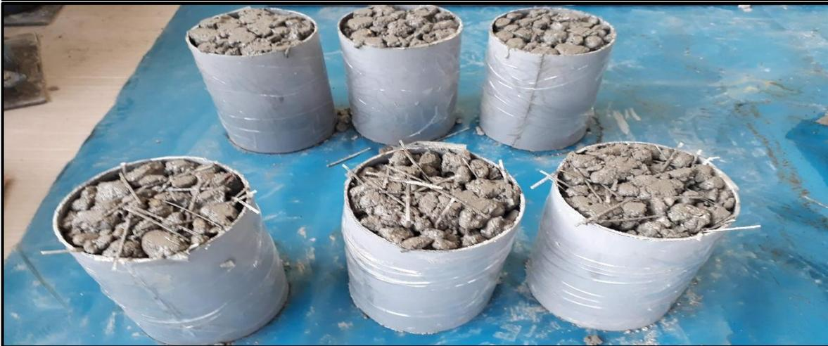
Figura 72: Especímenes elaborados para pruebas de permeabilidad
