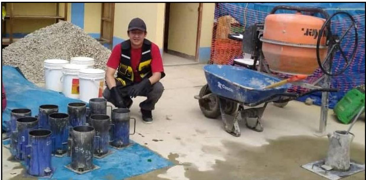
Figura 58: Preparación de materiales para pruebas patrones
