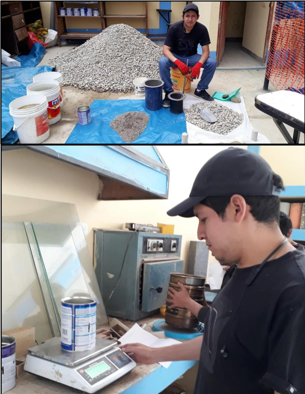
Figura 52: Ensayos para las características físicas de los agregados
