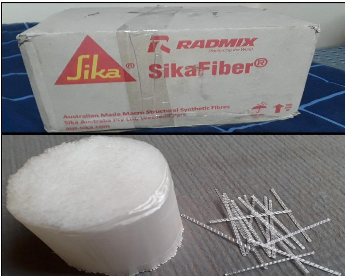
Figura 54: Fibras de polipropileno macro sintéticas estructurales usadas
