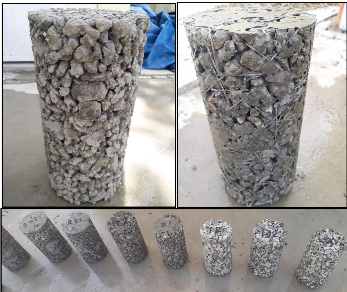
Figura 61: Desencofrado de los especímenes para su curado
