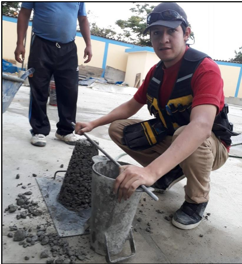
**Figura 80: Verificación de Slump 0" de la mezcla de concreto**
