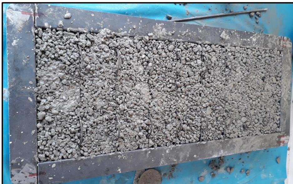
**Figura 77: Culminado de especímenes prismáticos con adición de nanosílice**
