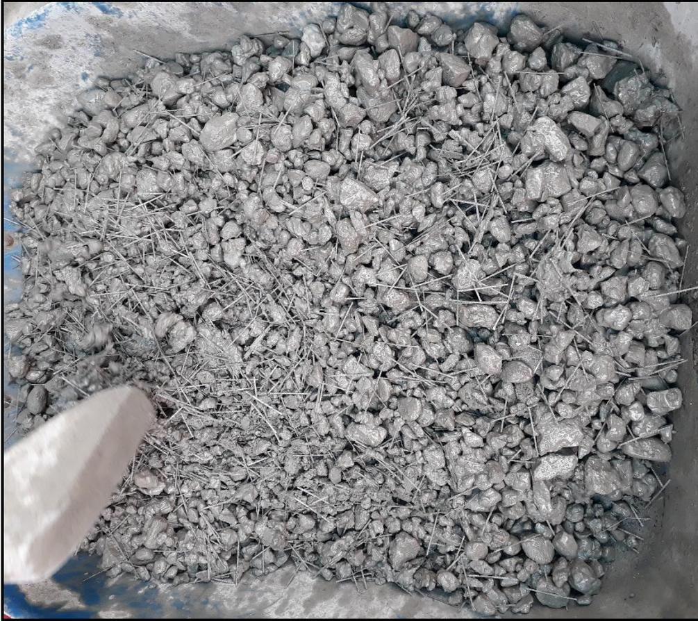
**Figura 78: Consistencia de la mezcla de concreto con nanosílice y fibras de polipropileno**
