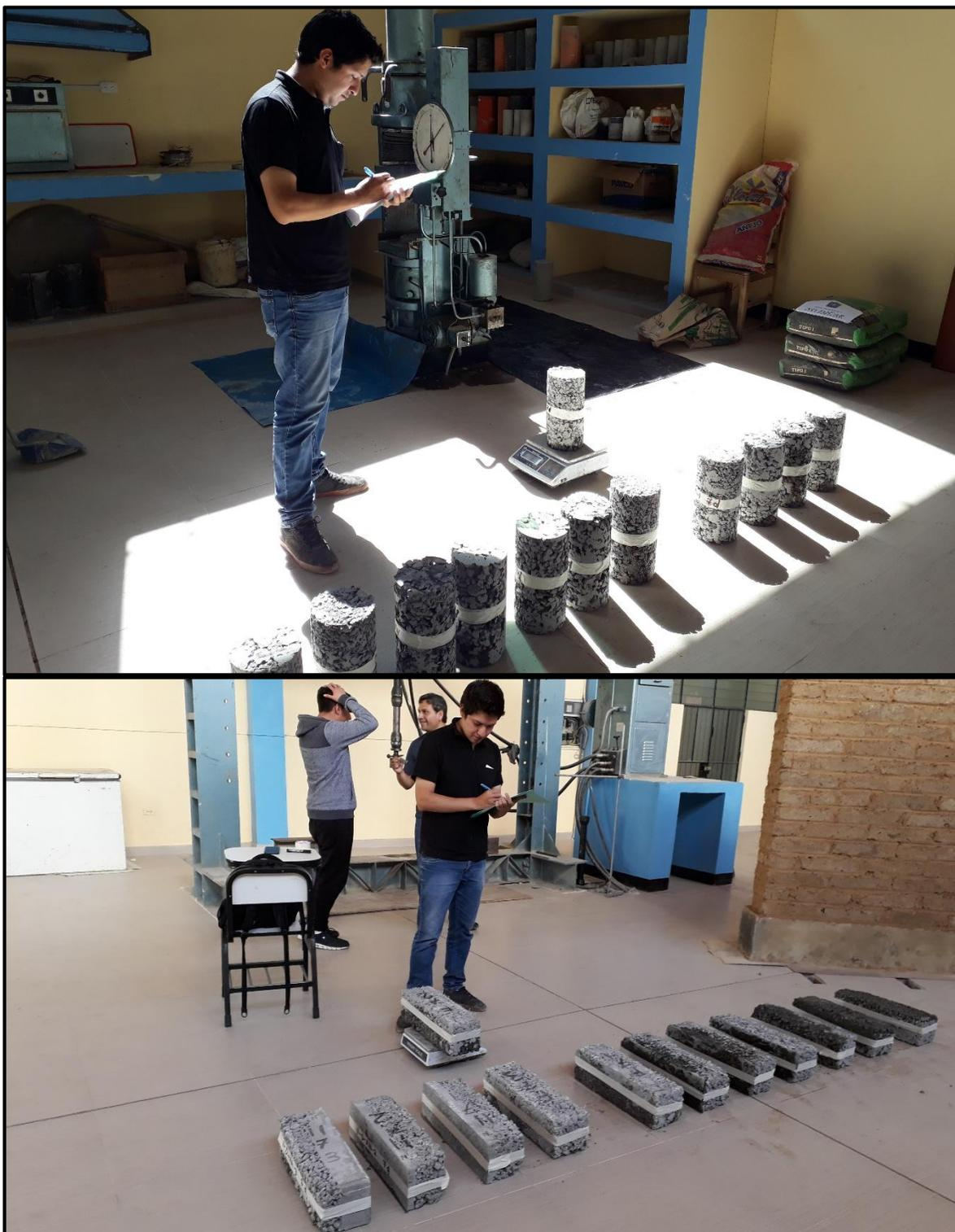
Figura 90: Ensayo de densidad de masa del concreto ecológico en estado endurecido
