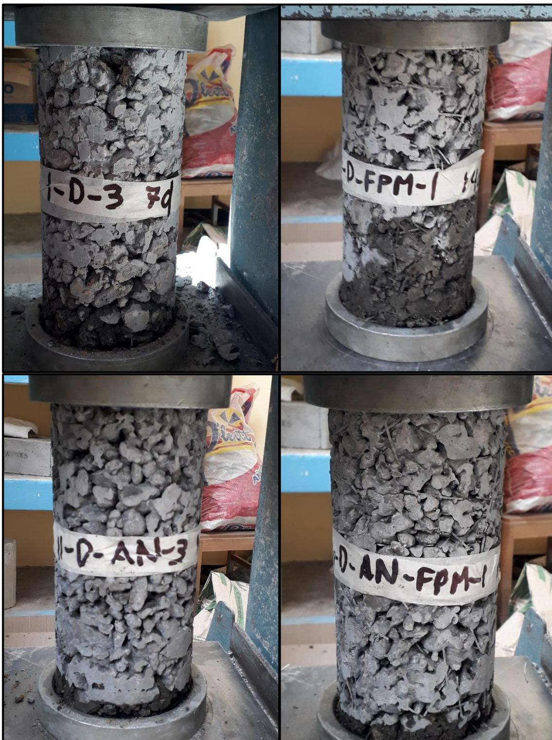
Figura 91: Verificación del tipo de fractura en los especímenes cilíndricos de concreto ecológico de las 4 dosificaciones a diferentes edades
