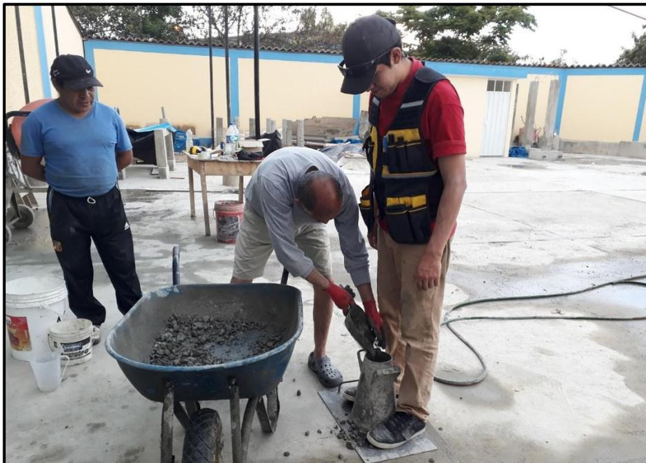
**Figura 79: Ensayo de revenimiento para medir el Slump de la mezcla de concreto**
