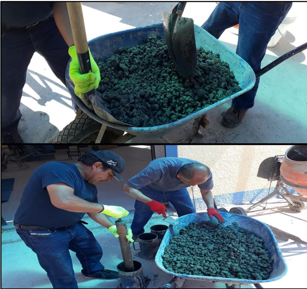
**Figura 65: Preparación de la mezcla y colocado en los moldes metálicos**
