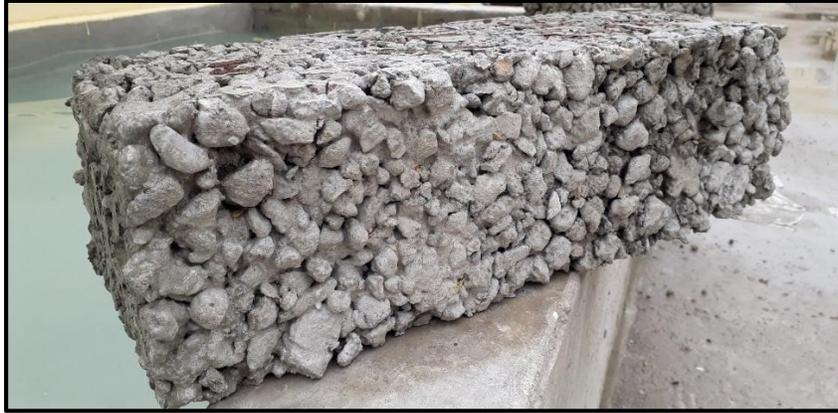
**Figura 84: Espécimen prismático con la adición de nanosilice trasladado a la poza para su curado**
