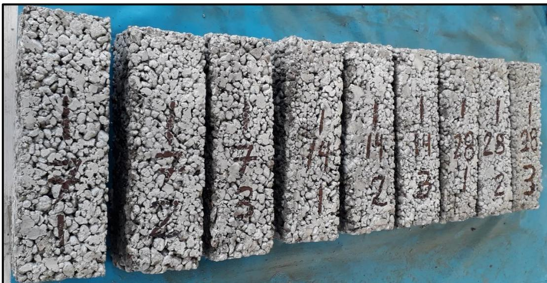
Figura 73: Codificación de las muestras prismáticas
