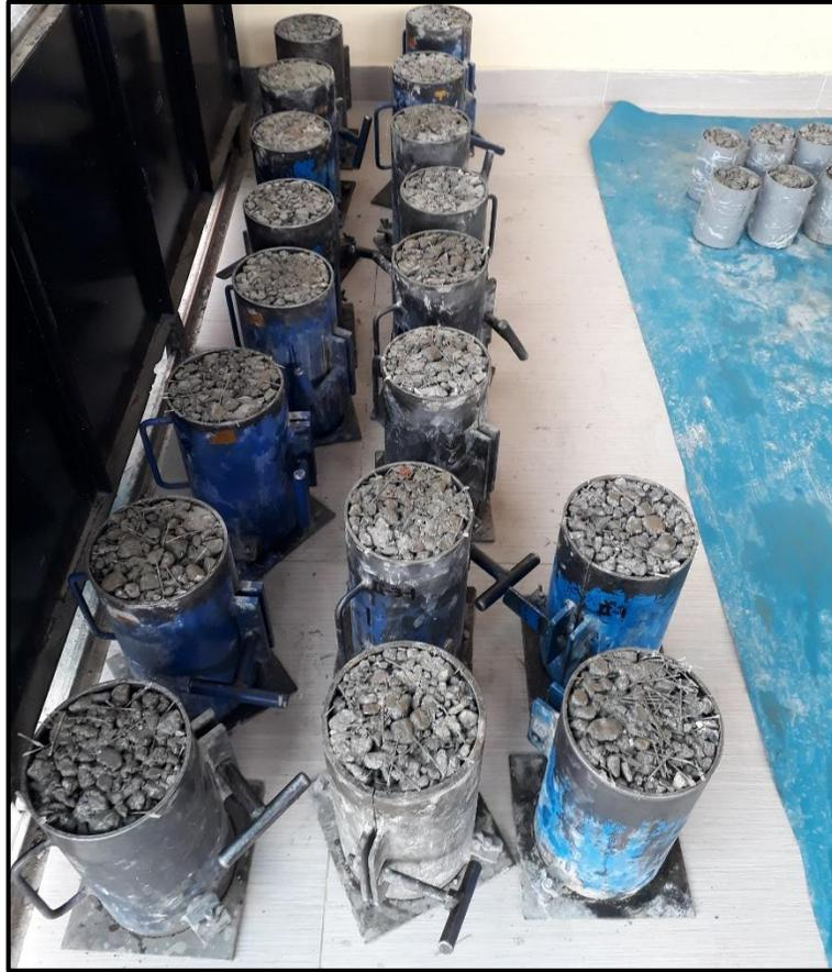
**Figura 82: Tanda de especímenes cilíndricos elaborados con la adición de nanosílice y fibras de polipropileno**
