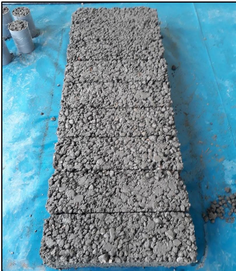
**Figura 71: Desencofrado de los especímenes prismáticos**
