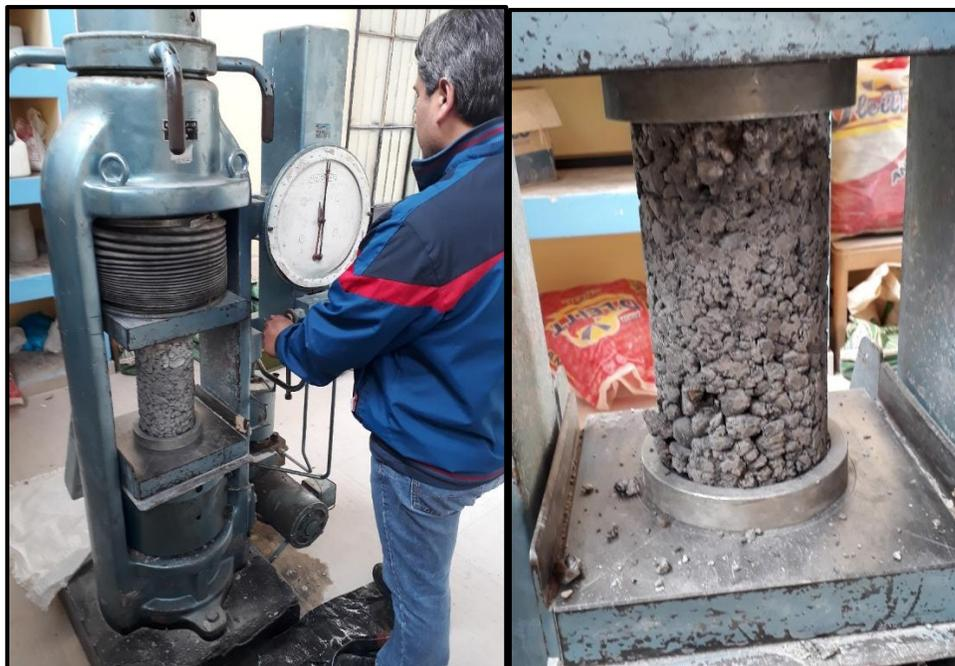
Figura 62: Rotura de los especímenes patrones para verificar su resistencia a 7 días
