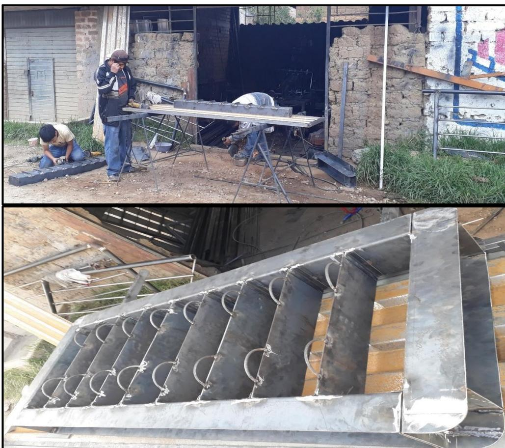
Figura 63: Visita al taller para la construcción de moldes metálicos de forma prismática
