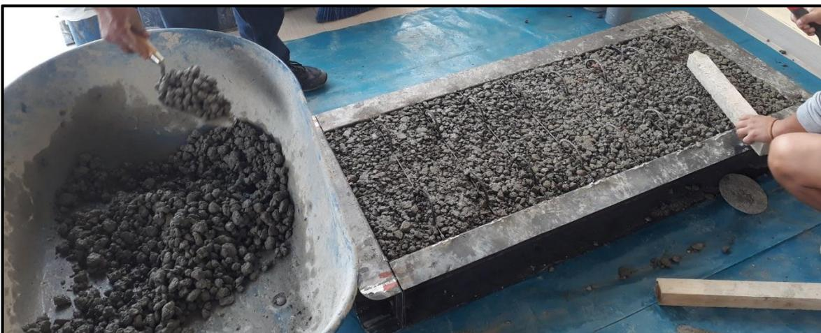
**Figura 68: Culminado de la colocación de la mezcla de concreto en el molde de especímenes prismáticos**
