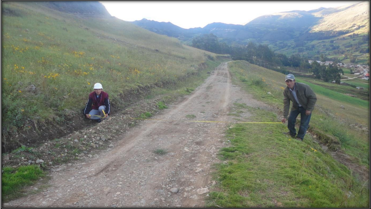
Foto A.5. Realizando medición de ancho de calzada de la carretera.
