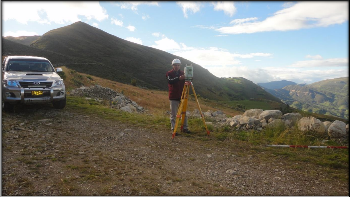
Foto A.2. Instalación de estación total en campo para realizar levantamiento topográfico.
