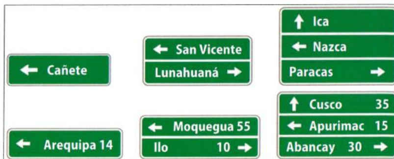
Figura 2.7. Ejemplo de señales informativas – de dirección. Fuente: MTC - Manual de Dispositivo de control del Tránsito Automotor para calles y carreteras (2016).
