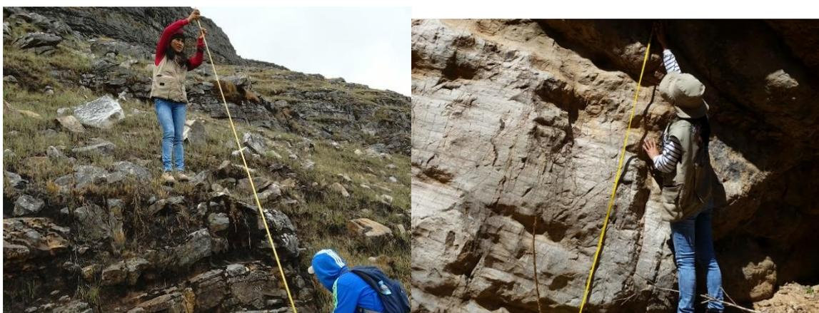
Foto 1. Levantamientos de las columnas estratigráficas en los sectores de San Cirilo (Izquierda) y Chilete (Derecha).
