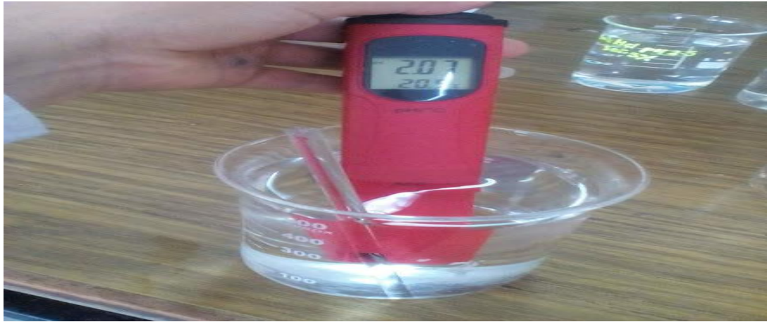
Figura 10: pH metro y solución de HCl a pH 2.0
