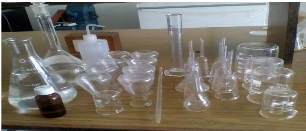
Figura 7: material de laboratorio (vasos Erlenmeyer, matraz, pipeta y probeta)
