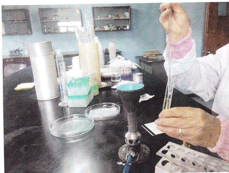
Fig. 16. Extracción de 1 mL del medio homogenizado para el sembrado.
