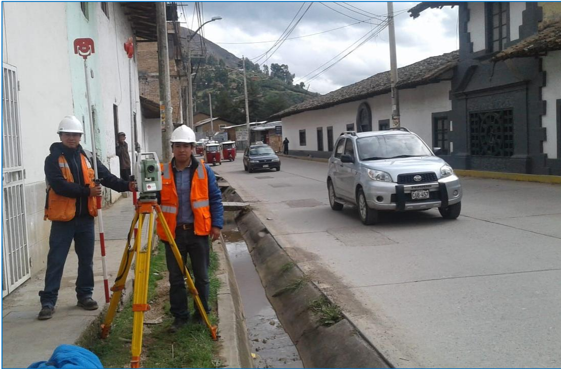
Descripción: Levantamiento topográfico con estación total Leica-TS06. Toma de datos del punto final.
