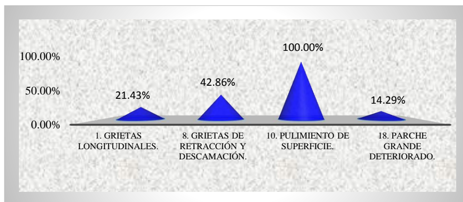
Figura N° 0 44: Densidad de cada tipo de falla en UM – 23.
