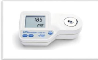
**Figura 11.** Refractómetro de bolsillo PAL – 3 marca atago. (Anexo 2.2).
