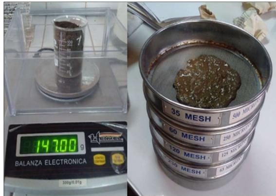
Figura 15. Técnica de tamizado en húmedo
