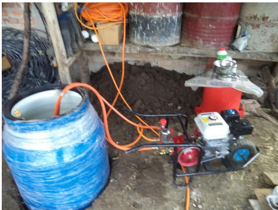
Fig. 3. Tanque, motobomba y accesorios para fumigación.
