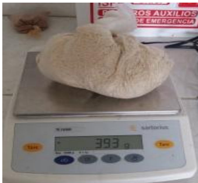
Figura 18. Balanza utilizada para el control de pesos
