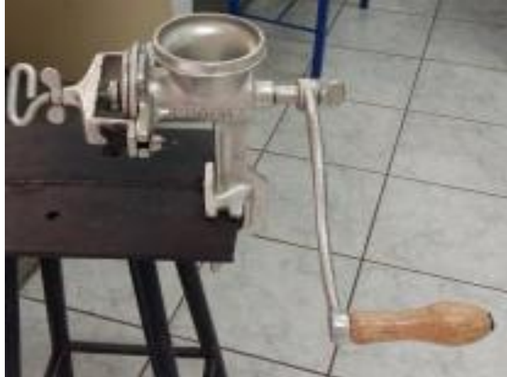
Figura 16. Molino manual usado para moler muestras de maíz
