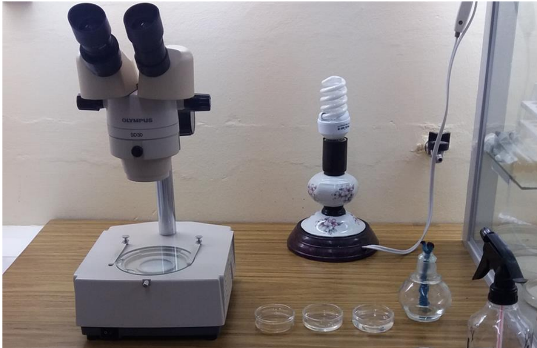
Fig. 31. Estereoscopio, lámpara eléctrica, placas de petri, mechero y aspersor: materiales usados para identificar a los fitopatógenos.
