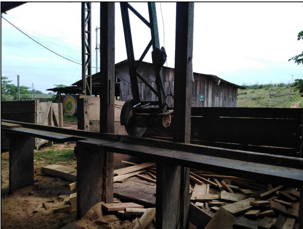
Fotos 17 y 18. Cantadora y despuntadora (shiffer)
