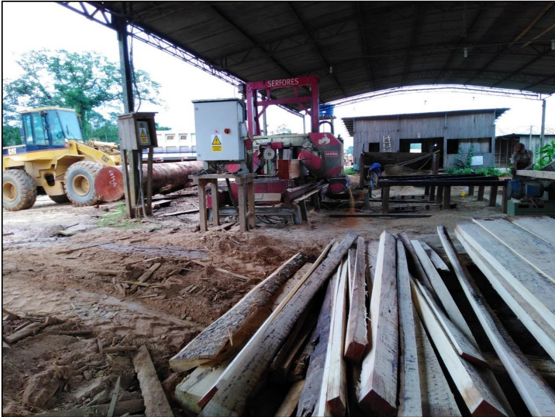
Foto 5. Ingreso de trozas de Copaifera reticulata D al aserradero a través de un cargador frontal 938 caterpillar
