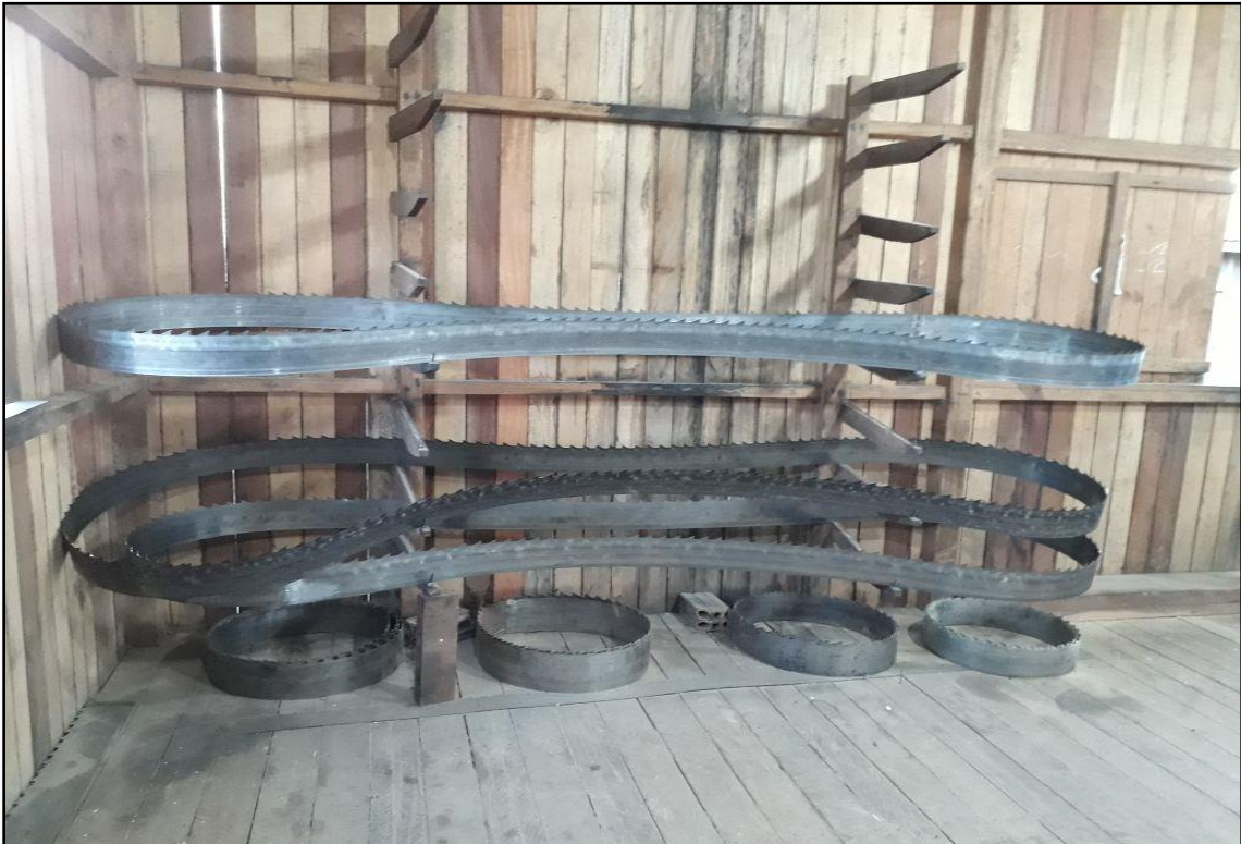
Fotos 12 y 13. Sala de Afilado de cintas para sierra horizontal.
