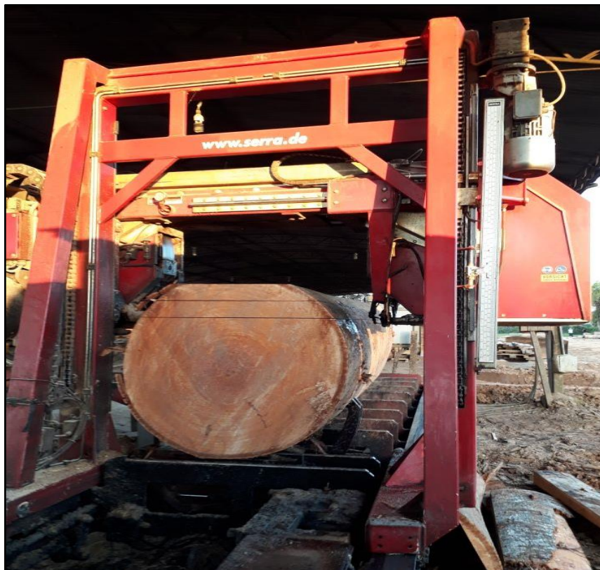
Foto 6. Primer corte de madera en sierra cinta horizontal de Ceiba pentandra (L.) Gaertn
