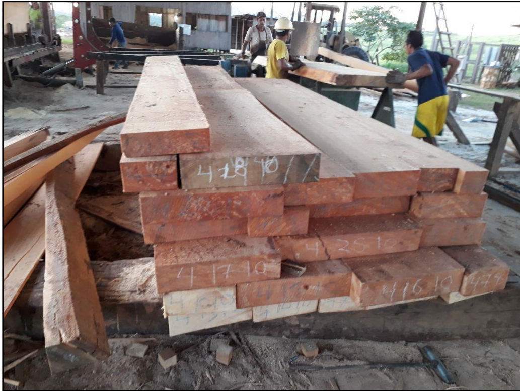
Foto 8. Proceso de canteado en tablonos de Ceiba pentandra (L.) Gaertn
