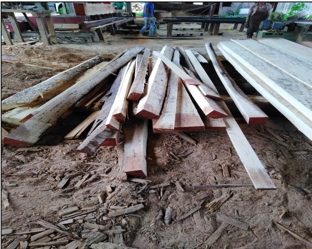
Foto 9. Proceso de canteado en tablonos de Copaifera reticulata Ducke
