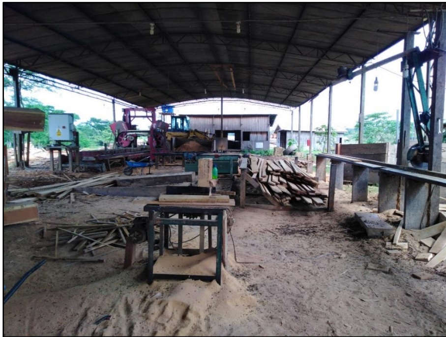
Fotos 14 y 15. Maquinas del aserradero GRUPO CARDOZO S.A.C. (Sierra cinta, canteadora, recuperadora y despuntadora)
