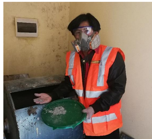
Imagen N° 9: Muestra de la CCA después de la molienda en la máquina de los ángeles.
