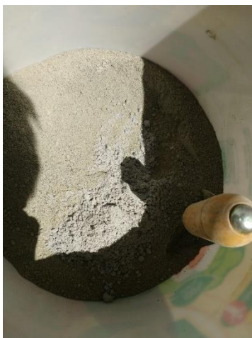
Imagen N° 18: Preparación de la mezcla para la elaboración de los morteros con incorporación de CCA
