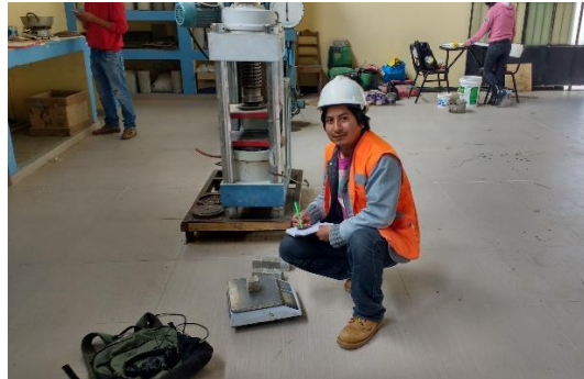
Imagen N° 25: Pesaje de los morteros antes de ser ensayados.
