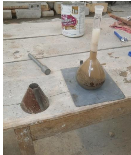
Imagen N° 3: Agregado fino saturado superficialmente seco, frasco lleno con muestra y agua hasta la marca de 500cm 3 .
