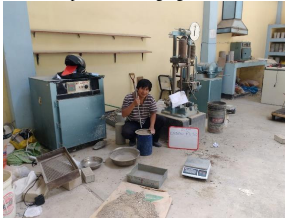
Imagen N° 8: Molienda de la CCA en la máquina de los ángeles.
