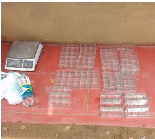
Imagen N° 16: Preparación de los moldes para la elaboración de los morteros con Ceniza de cáscara de arroz.
