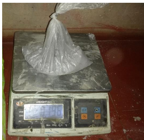
Imagen N° 17: Pesaje de la Ceniza de cáscara de arroz para adicionar en reemplazo del cemento
