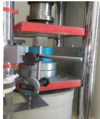
Imagen N° 27: Ensayo a compresión de especímenes de mortero con adición de cca.
