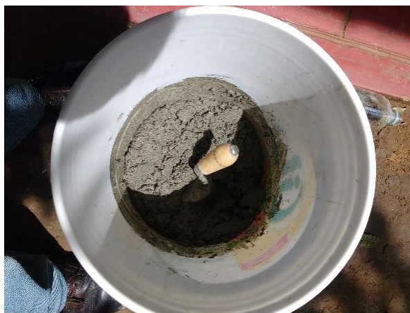
Imagen N° 18: Preparación de la mezcla para la elaboración de los morteros con incorporación de CCA
