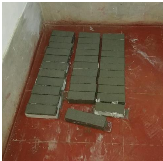
Imagen N° 21: Fotografía de los morteros elaborados en estado fresco
