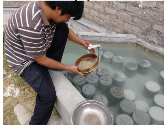
Imagen N° 9: Muestra de la CCA después de la molienda en la máquina de los ángeles.
