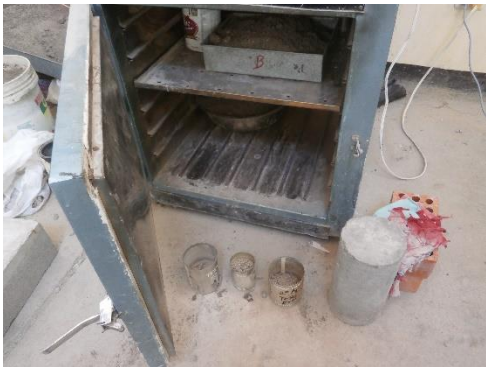
Imagen N° 6: Peso unitario seco compactado del agregado fino.
