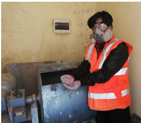
Imagen N° 8: Molienda de la CCA en la máquina de los ángeles.
