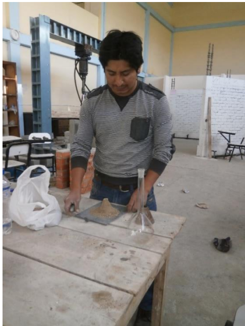
Imagen N° 3: Agregado fino saturado superficialmente seco, frasco lleno con muestra y agua hasta la marca de 500cm 3 .
