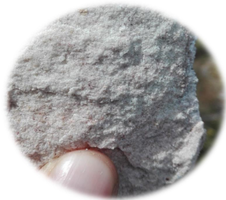
Fotografía 52: Coordenadas: 9207996N, 782167E, Cota: 2940msnm. Arenisca cuarzosa de grano medio a grueso.
