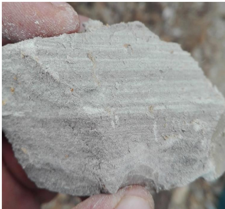
Fotografía 27: Laminación paralela en lutitas cercano al contacto con la Formación Farrat.
