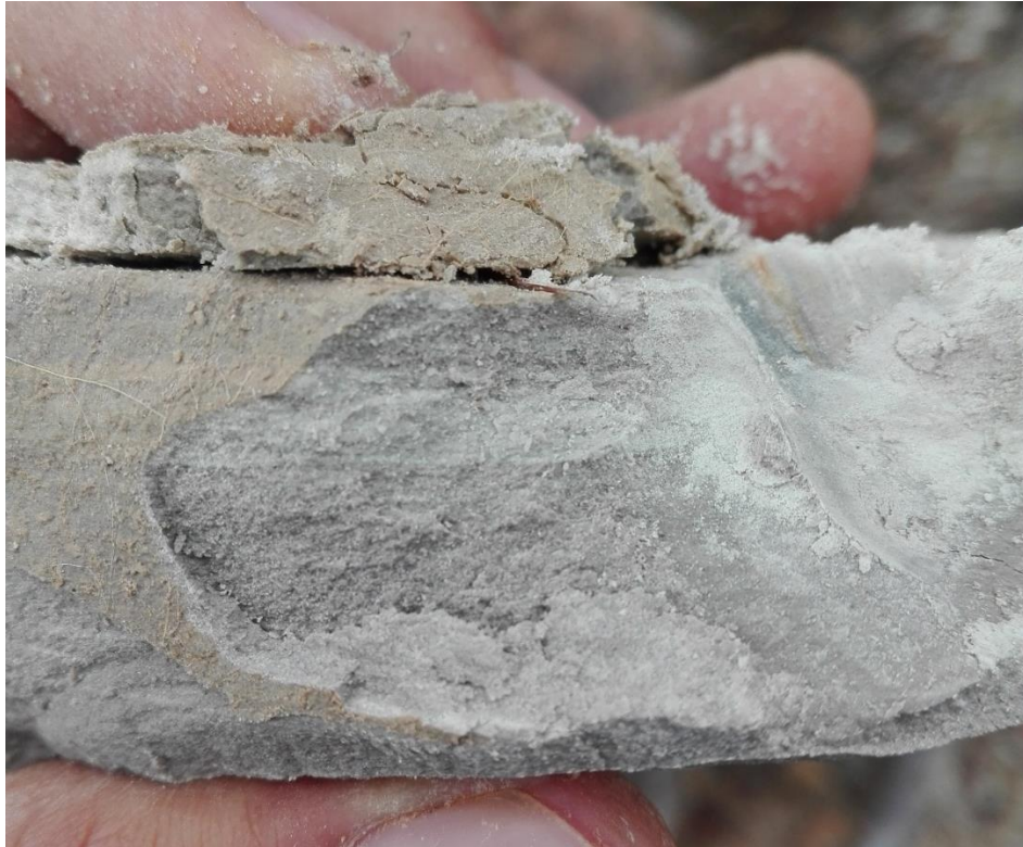
Fotografía 25: Coordenadas: 9207082N, 783447E, Cota: 2972msnm. Lutitas grises hacia el techo de la Formación Carhuaz
