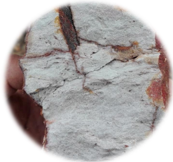
Fotografía 49: Coordenadas: 9206332N, 783141E, Cota: 2845msnm. Arenisca cuarzosa blanquecina de la Formación Carhuaz.
