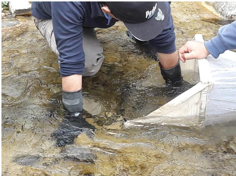
**Figura 10.** Método cuantitativo de colecta empleando red Surber
